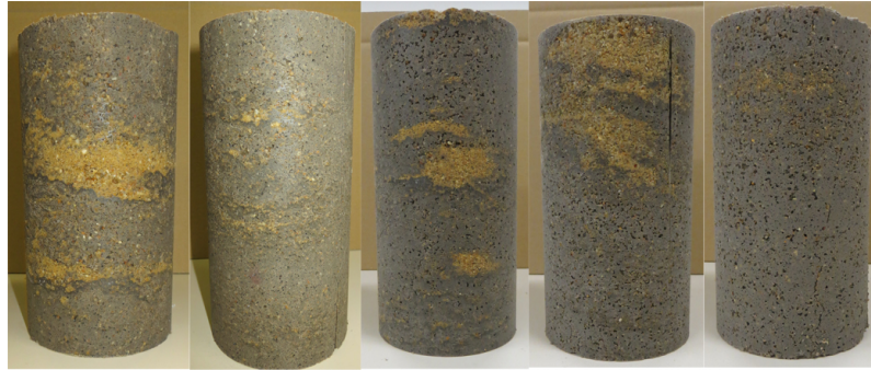
Abbildung 4.22.: Ungleichmäßige Penetration der Injektionskörperproben
