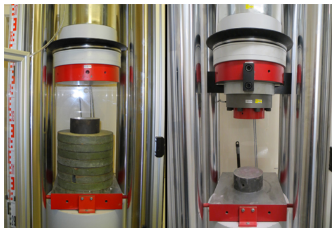
Abbildung 4.30.: Hydraulische Prüfpresse mit 1.500 kN (links) und 250 kN Kraftmessdose (rechts)
