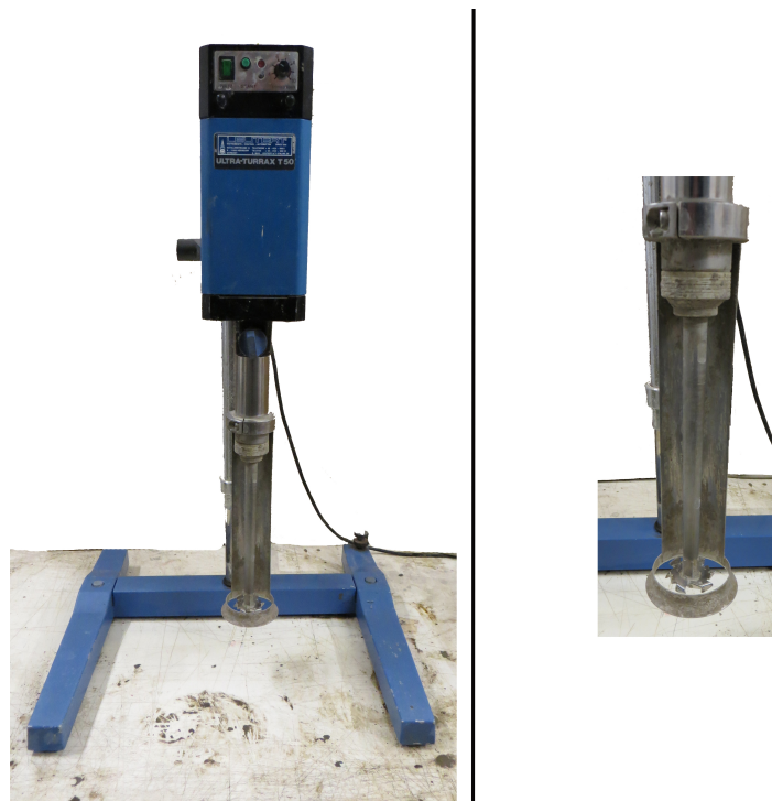
Abbildung 4.4.: Links: Mischer Ultra-Turrex T50; Rechts: Mischwerkzeug
