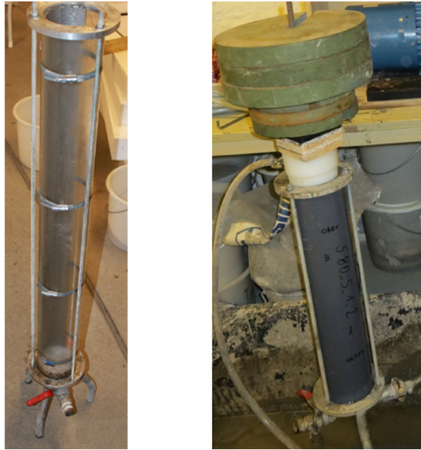
Abbildung 4.20.: Links: geschlitzter Injektionszylinder; rechts: geschlossener Injektionszylinder
