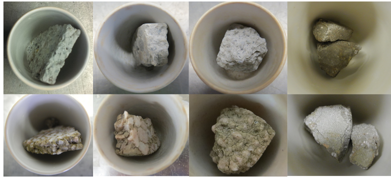
Abbildung 4.24.: Probekörper vor (oben) und nach (unten) Bestimmung der Masse des chemisch gebundenen Wassers
