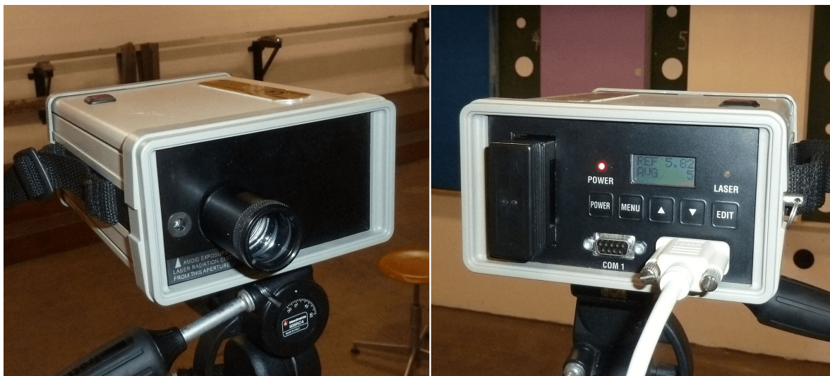
Abbildung 4.3: Spektroradiometer „GER 1500“ der Firma SVC. Links : Optik des Radiometers (im Vordergrund). Rechts : Bedienfeld und serielle Schnittstelle des Gerätes.
