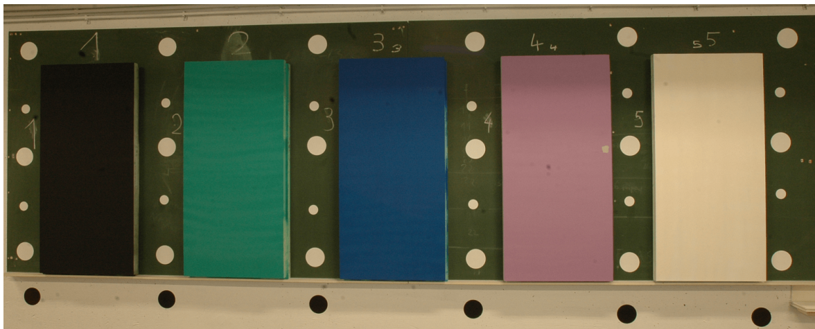
Abbildung 5.4: Endgültiges Kalibrierfeld: Fünf Styrodurtafeln, die mit unterschiedlichen Farben besprüht sind. Rund um die Platten ist das bereits angebrachte Passpunktfeld zu sehen. Um einen guten Kontrast der Passpunkte auf dem jeweiligen Hintergrund zu erhalten, wurden weiße und schwarze Passpunkte verwendet.
