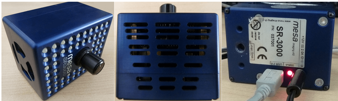
Abbildung 4.1: Verschiedene Ansichten der Swissranger 3000. Links : Beleuchtungseinheit und Optik. Mitte : Lüftungsschlitze für die Kühlung der Elektronik. Rechts : Rückseite der Kamera. Zu sehen sind die angeschlossenen Kabel für die Datenübertragung und die Energieversorgung.
