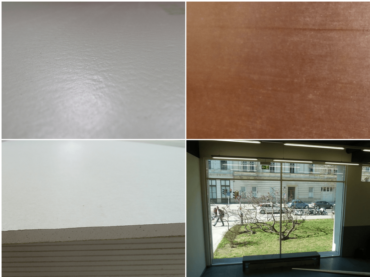
Abbildung 5.1: Mögliche Flächen für eine Kalibrierung. Links oben: Oberfläche von Styrodur. Rechts oben: Oberfläche einer Siebdruckplatte. Links unten: Feuerschutzplatte. Rechts unten: eine 3 m x 4 m große Glasscheibe auf der TU Wien.
