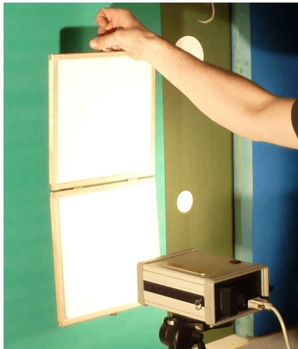
Abbildung 4.4: Kalibrierung des Spektrometers vor jeder Messung mit einer Referenzmessung auf Spectralon.
