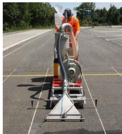
**Abbildung 89: Restsalzmessgerät Spül-Saug-Gerät der Firma ESG [18]**
