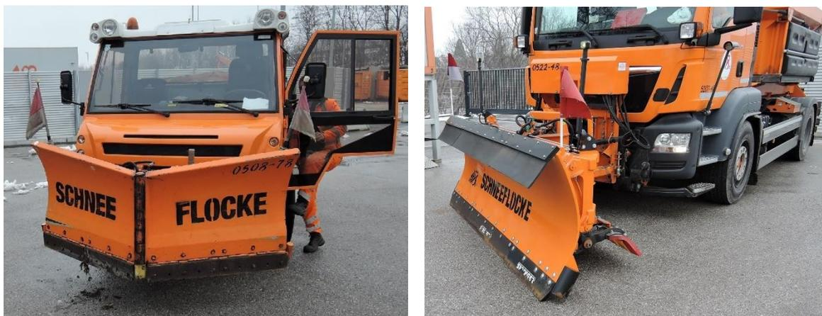
**Abbildung 49: v.l.n.r. Flötzing DKV-A und Springer SHL 3204 mit Nachräumklavier**
