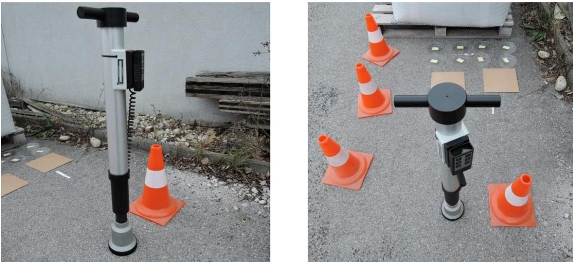
Abbildung 59: SOBO20 Restsalzmessgerät
