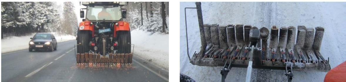
**Abbildung 57: Feldversuch Verschleiß der Räumleisten**
