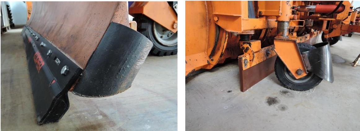
Abbildung 50: Küper Kombi S50 Wave Räumleiste und Nachräumleiste
