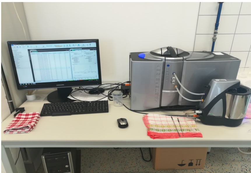
Abbildung 3.8: Verwendetes Partikelgrößenmessgerät Mastersizer 3000
