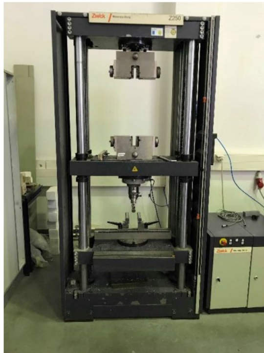
Abbildung 3.9: Verwendete Prüfmaschine für Biegezugversuche der Fa. Zwick
