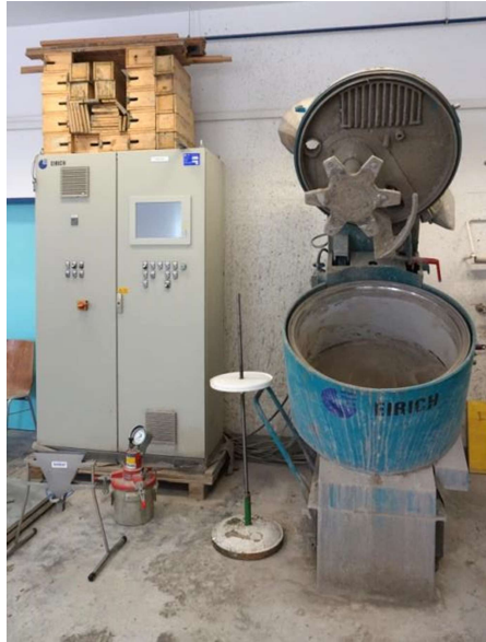
Abbildung 3.2: Eirich R08W Intensivmischer zur Herstellung des Prämix
