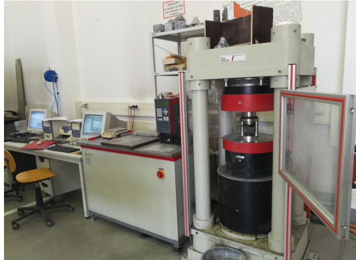
Abbildung 3.10: Verwendete Prüfmaschine für Druckversuche der Fa. Toni Technik
