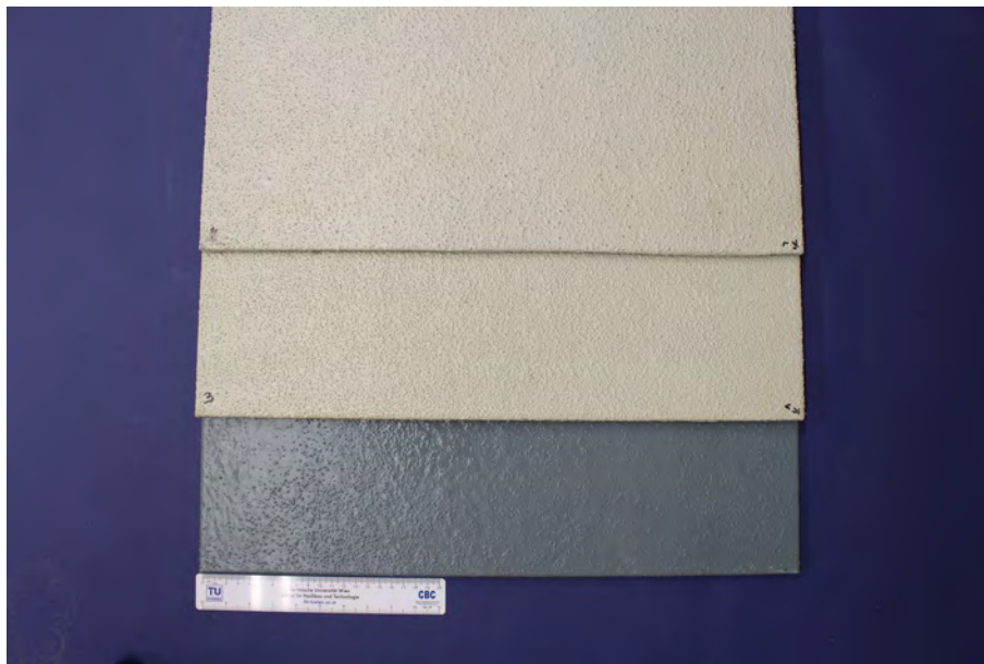
Abb. 3.5: Testbeläge von unten nach oben: T1 ( \mu = 0,57 ), T2 ( \mu = 0,61 ) und T3 ( \mu = 0,66 )
