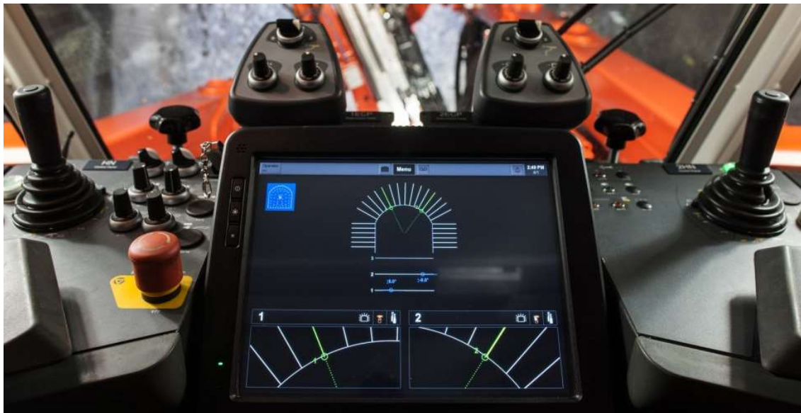
Abb. 4.5: Digitale Bohranweisung und Bohrsteuerung [25]
