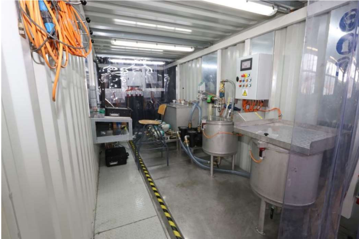
Abb. 3.7: Mobile Injektionsanlage für Acrylatgelinjektionen [5]
