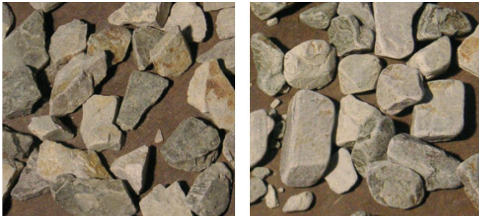
Abbildung 2.14: Gesteinsprobe vor und nach einem Micro-Deval-Versuch [14]
