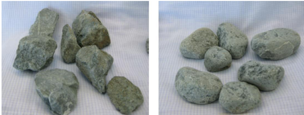
Abbildung 2.11: Gesteinsprobe vor und nach einem Los-Angeles-Versuch [14]
