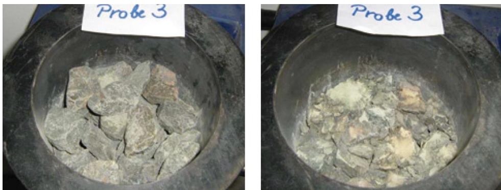
Abbildung 2.12: Gesteinsprobe vor und nach einem Schlagzertrümmerungsversuch [14]
