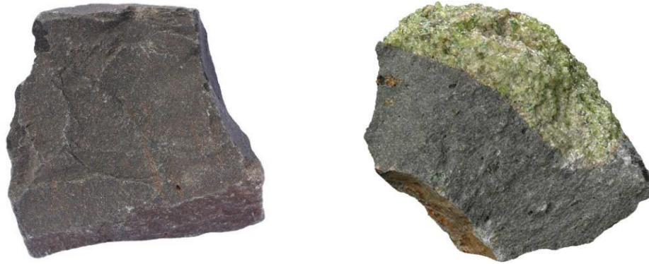
Abbildung 2.3: a) „gesunder“ Basalt b) Sonnenbrandbasalt mit hohem gelbem Anteil an Olivin [47]
