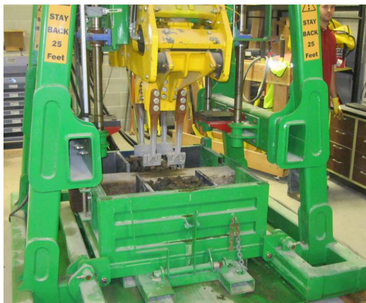
Abbildung 2.19: Versuchsaufbau zur Simulation von Stopfarbeiten [5]
