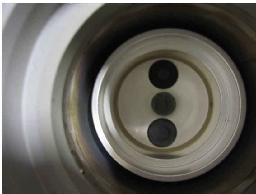
Figure 2.10: DSC 204 F1 Phoenix - furnace
