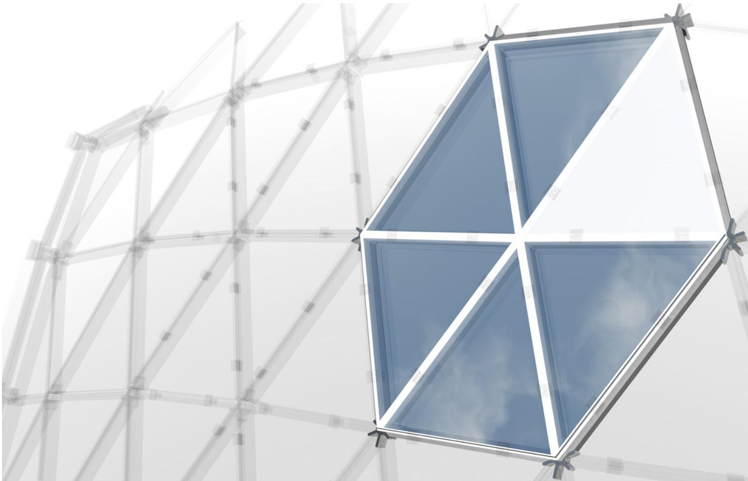
Abb. V.4.7: 3-D Darstellung Fassadenaufbau
