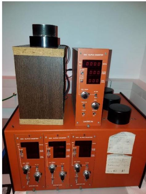
Abb. 29 Alphazähler mit dem die Eigenaktivität der einzelnen Proben bestimmt wurde
