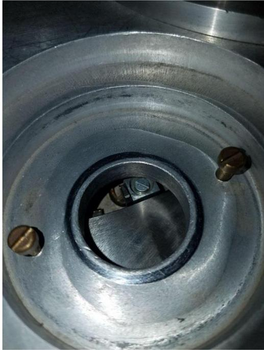
Abb. 34 Öffnung zum Bestücken der Probenkammer; Gasdichter Verschluss
