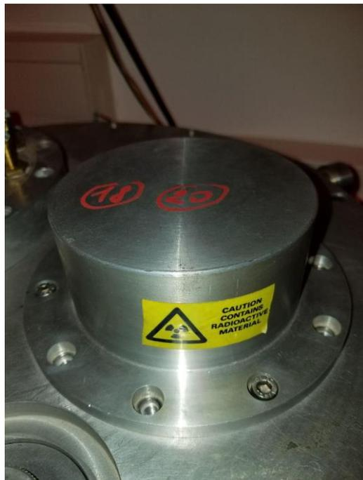
Abb. 35 Radioaktive Quellen für die Bestrahlung der einzelnen Probendisks mit  $\alpha$ - und  $\beta$ -Strahlung
