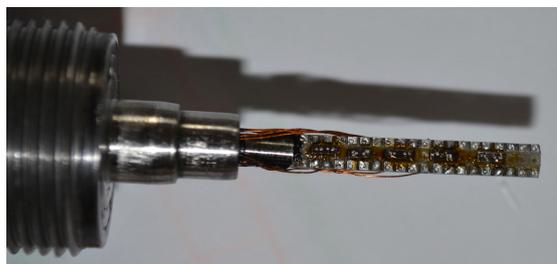
Abbildung 2.6.: Probenhalter mit angebrachten Proben
