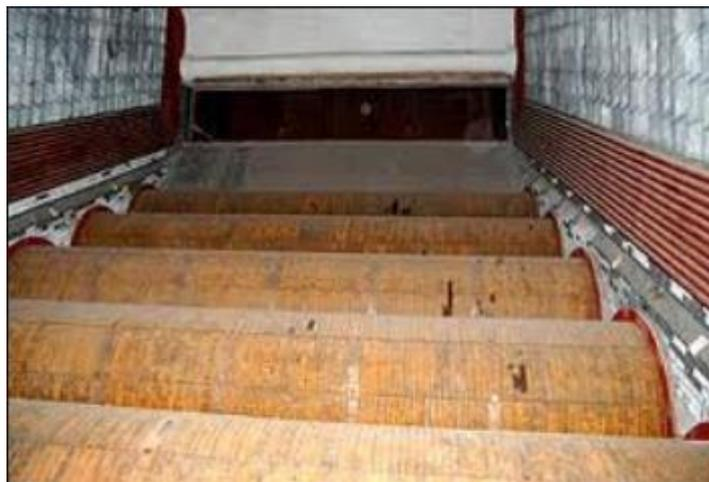
Abb.:16 Ansicht eines Walzenrostes<sup>14</sup>
