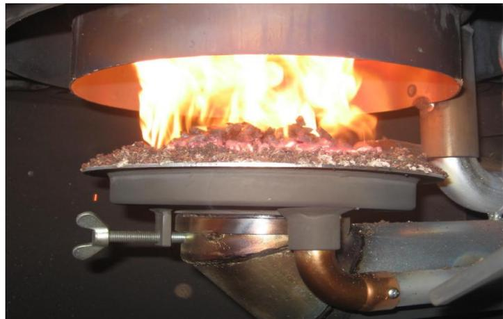
**Abb.: 19 Ansicht einer Unterschubfeuerung<sup>17</sup>**
