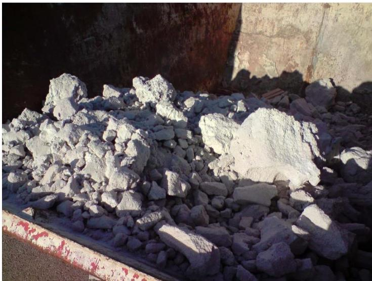
Abb.21.: Nach einem Kesselzusammenbruch ein Teil der entfernten Menge an Agglomeraten die u.a die Zirkulationswege im Inneren des Kessel verlegt hatten. Glatte Flächen deuten darauf hin, dass der Agglomerat an Wänden/Einbauten angehaftet war.
