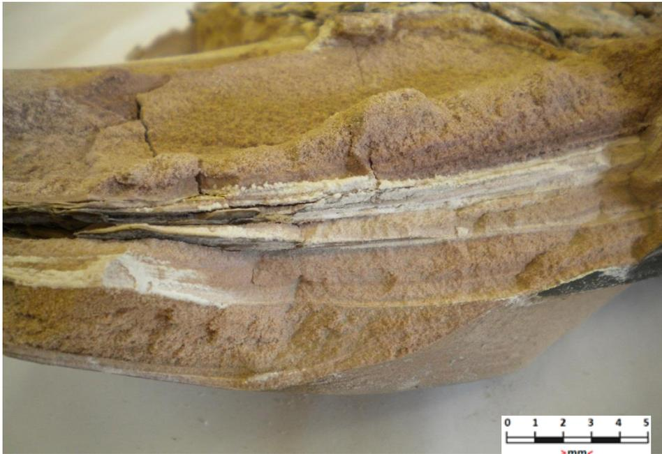
Abb.21j: Schichtungen in den „Sinterungen“<sup>30</sup>
