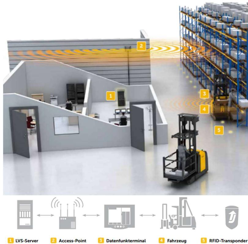
Abbildung 26: Jungheinrich RFID - Transponder System <sup>202</sup>
