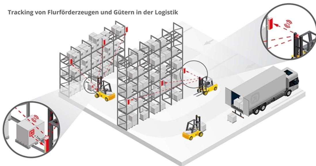
**Abbildung 32 insoft-Warenortung mit kombinierter UWB/RFID Technologie**<sup>248</sup>
