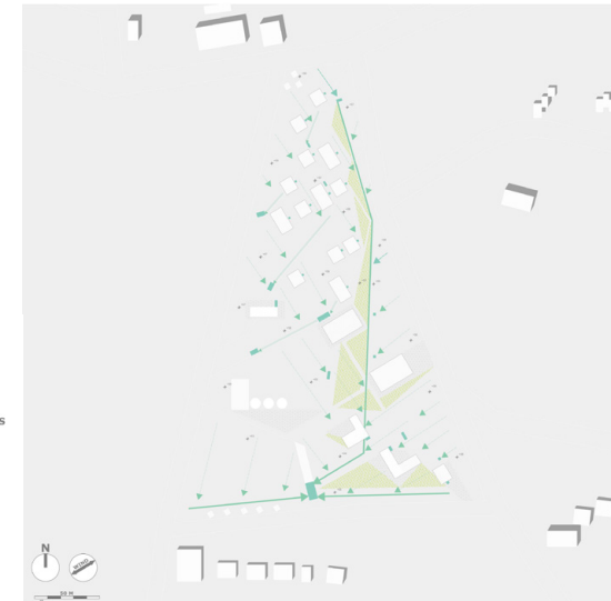
Abb. 151. Leitung und Speicherung Oberflächenwasser Grundstück
