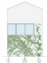
Flächenförmiger Direktbewuchs der Fassade
