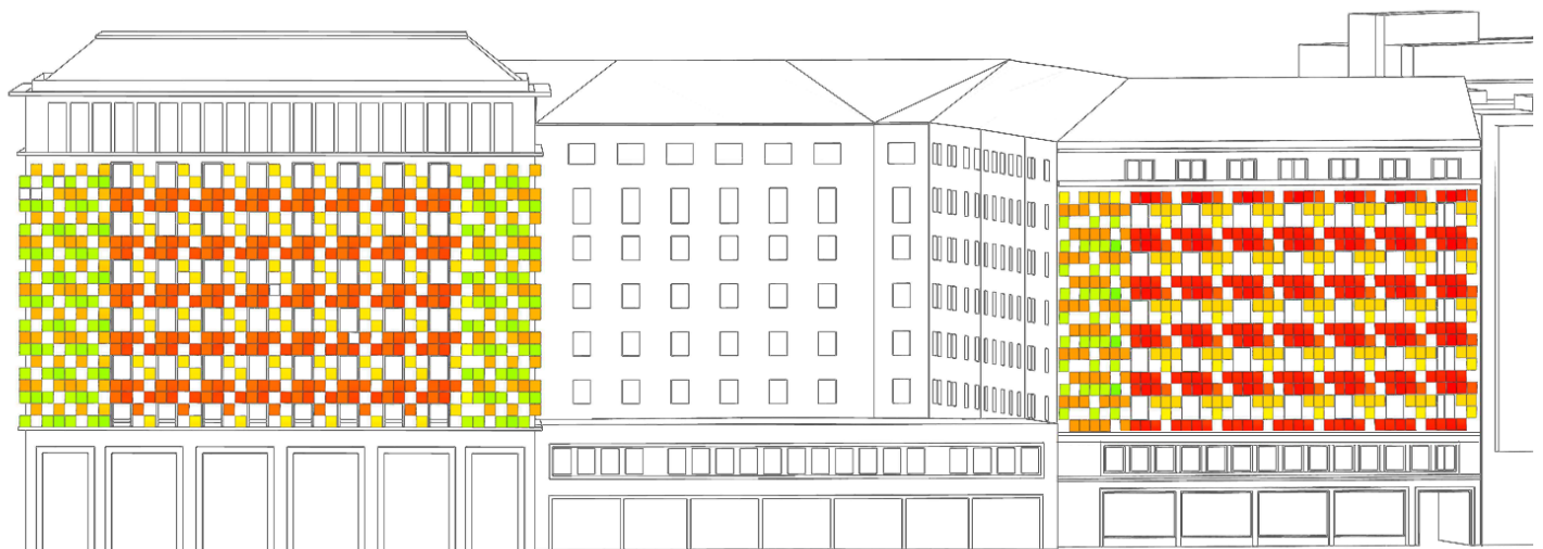
Abbildung 109: Jahreseinstrahlung auf den Fassaden der Stiege 1 und Stiege 7
