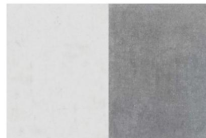
BETONPLATTEN MIT BASALTZUSCHLAG SANDGESTRAHLT/
