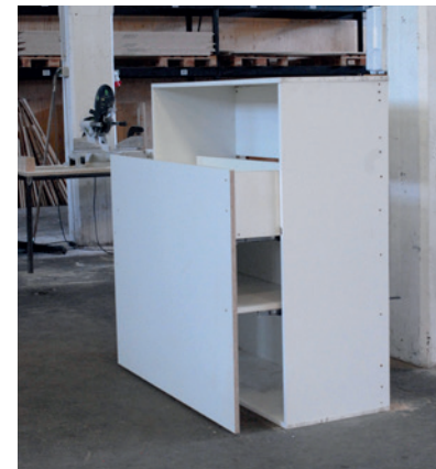
Test der Auszugssysteme mit montierter Blende
