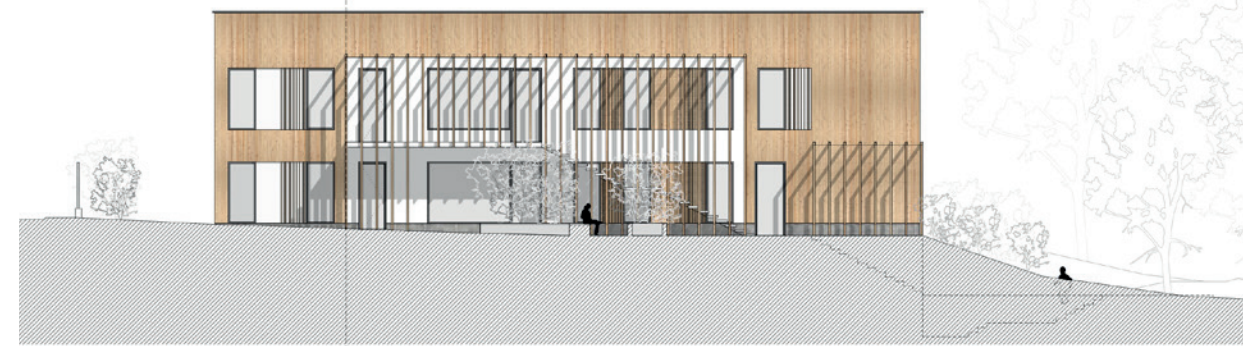
Holztafelfassade | Putz im Bereich der Pergola | Alufenster | Holzschiebeelemente | Pergola aus Holz | Netz als Absturz-sicherung
