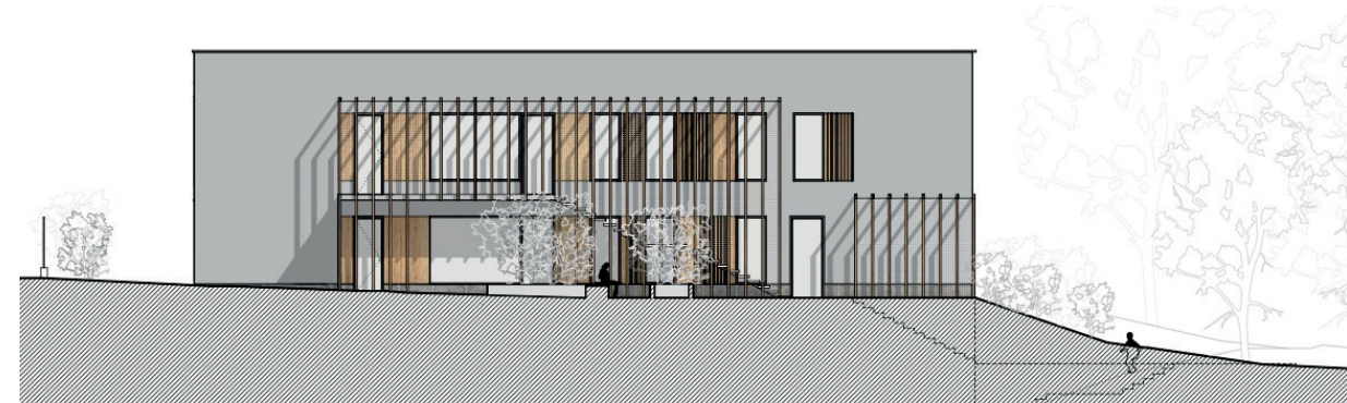
Varianten zur Fassadengestaltung | Pergola Südost | Nordost mit Verdunklung für Zimmer
