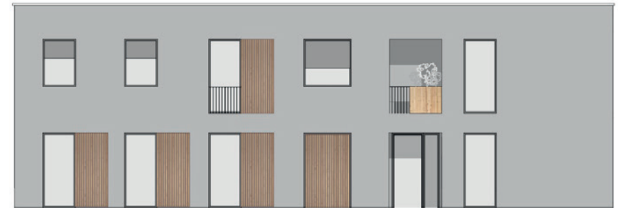
FSJ offenbar | Stiegenhaus & Büro fixverglast | Verschattung vertikal
