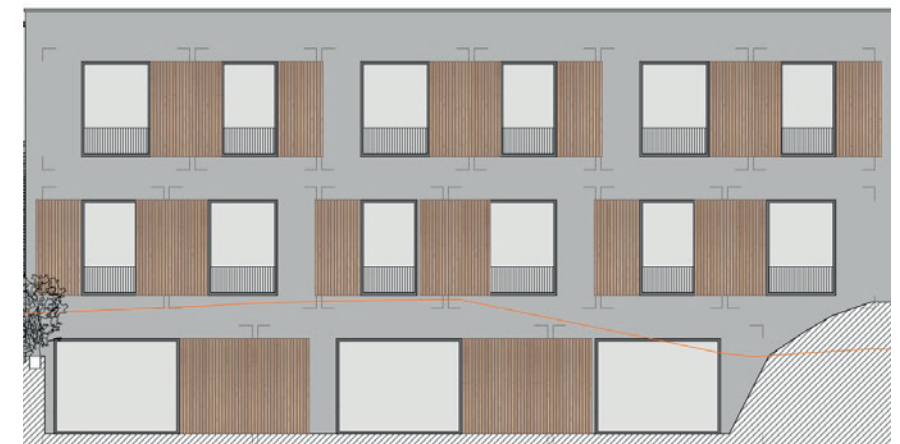
Fassade Nordost | Zimmerzeile | Öffnungsflügel mit Sitzparapet und franz.Balkon
