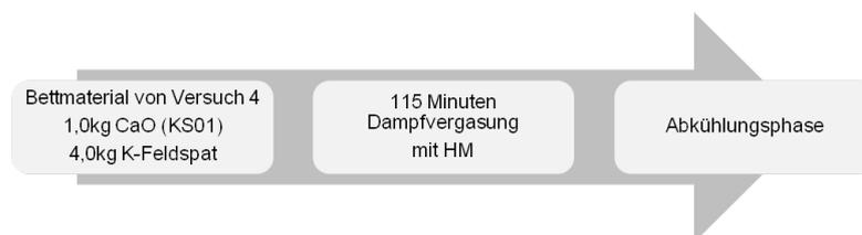
**Abbildung 53:** Schematische Durchföhrung der Zweibett-Wirbelschicht-Dampfvergasung für Versuch 5
