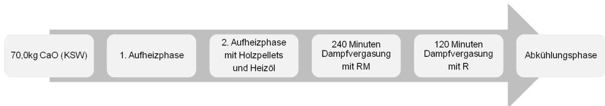
**Abbildung 39:** Schematische Durchführung der Zweibett-Wirbelschicht-Dampfvergasung für Versuch 3
