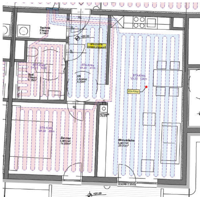
Abbildung 29: Heizungsverrohrung Projekt TBA - Planausschnitt
