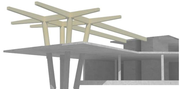
Bei diesem Tragwerk gehen die Stützen von unten nach oben durch, sind jedoch aus zwei verschiedenen Materialien ausgeführt. Es besteht das gleiche Problem der Lastübertragung von den oberen Stützen nach unten.
