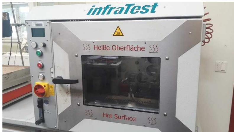
**Abbildung 10 RTFOT Wärmekammer mit innenliegendem Drehgestell**
