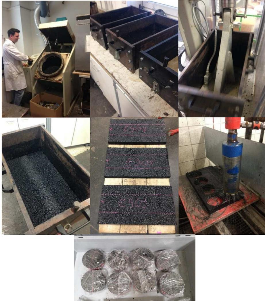
**Abbildung 6 Ablauf Plattenherstellung von links oben: Asphaltmischgut im Gegenlaufzwangsmischer bis unten mitte: fertige ausgebohrte Probekörper**
