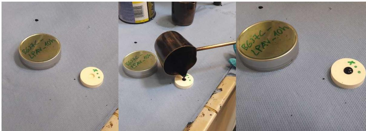
**Abbildung 20 Links: Silikonform und beschriftete Schutzhülle, mitte: eingießen des flüssigen Bitumens aus Kännchen in Silikonform, rechts: befüllte Silikonform**
