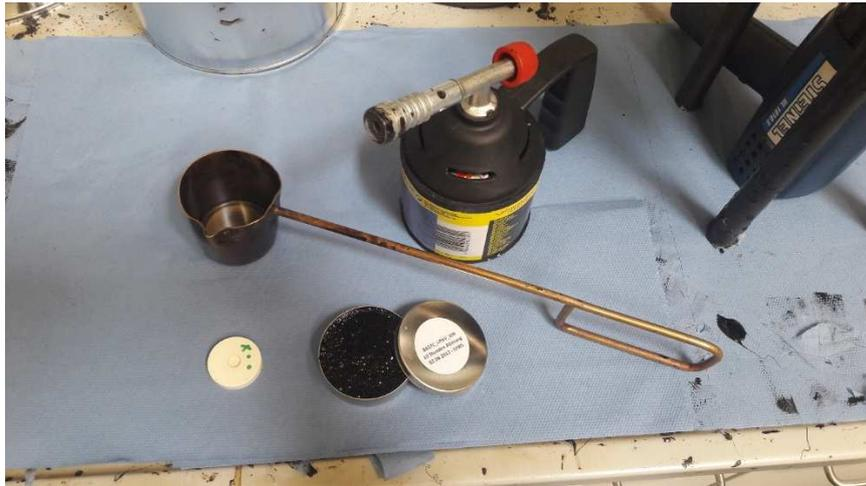
**Abbildung 19 DSR Probenvorbereitung Silikonform, Bitumenprobe, Kännchen und Vorrichtung zum Erwärmen**
