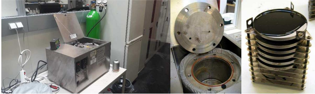
**Abbildung 12** Links: Pressure Aging Vessel, mitte: Druckluftbehälter, rechts: Schalenanordnung
