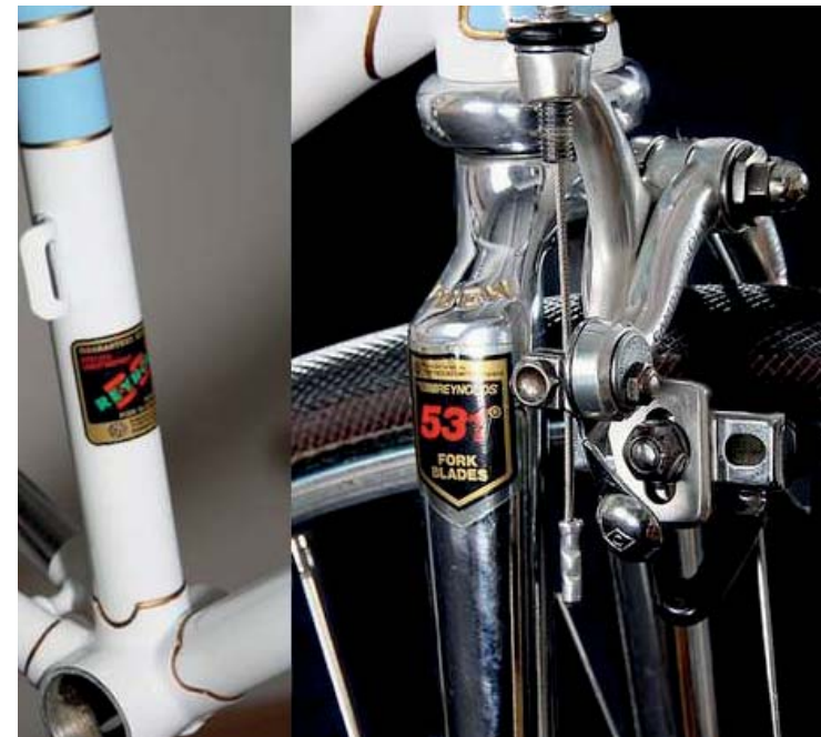
3.3.2 Detail Tretlagergehäuse / Gabel mit Campagnolo Super Record Bremskörper
