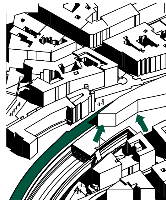
- grobe Kubatur des Baukörpers - Reaktion auf den Stadtraum - Reaktion auf den Verkehrslärm
