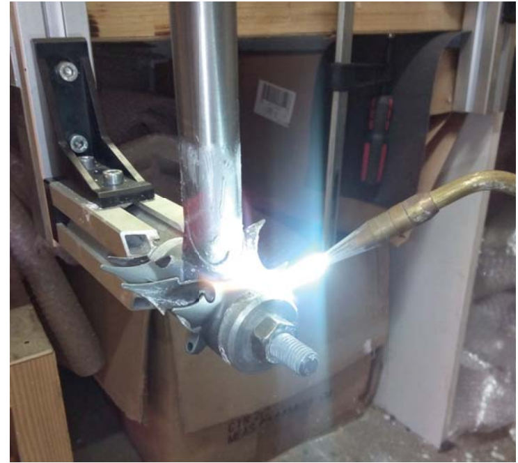
3.6.3 Einlöten eines angepassten Sitzrohres in die Tretlagermuffe
