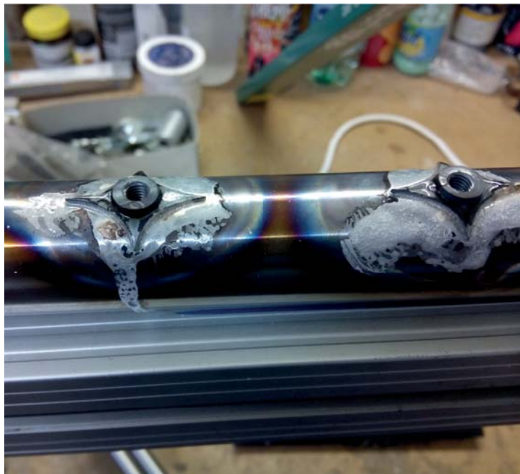
3.6.5 eingelötete Flaschenhalterösen, unversäubert mit Flußmittelresten
