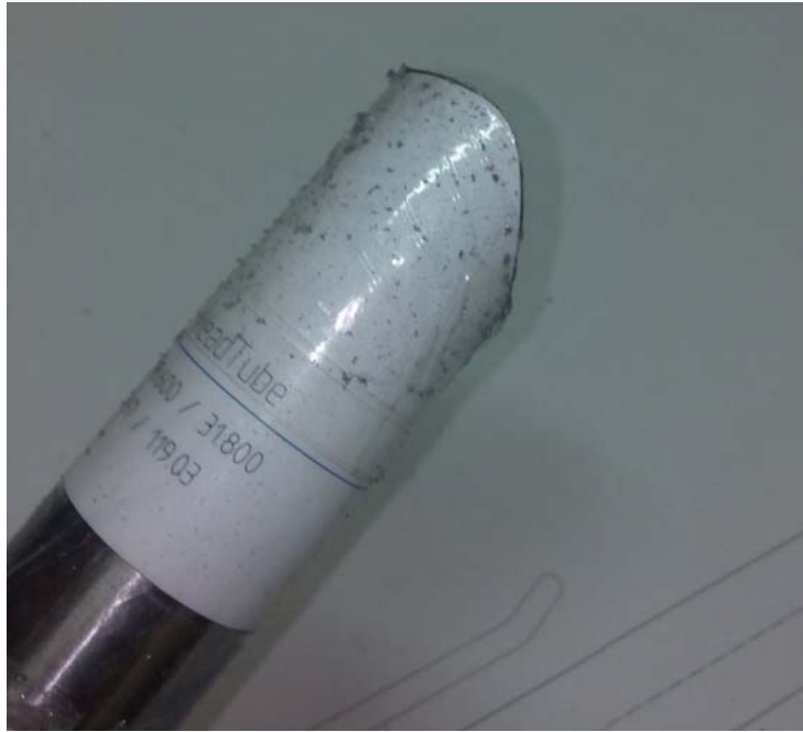
3.6.2 Feilen der Rohrverschneidungen mit aufgeklebter Schablone
