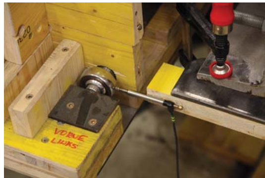
(b) Nachgiebigkeitsmessung an den Gelenken beim Auflager
