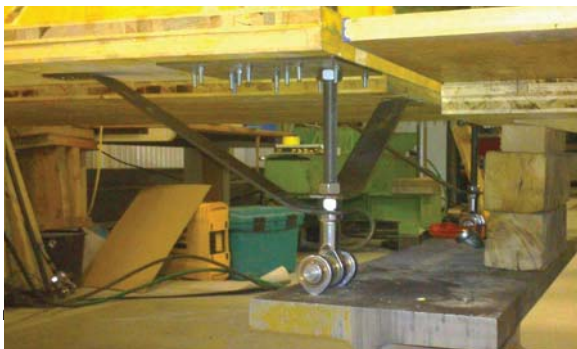
(a) Lagerkonstruktion (aus [Zip15], bearbeitet)
