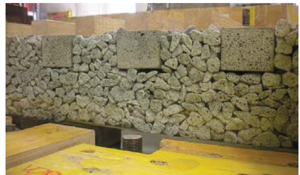
(b) Blick auf den Schotterbettlängsschnitt im Fahrbahnübergangsbereich
