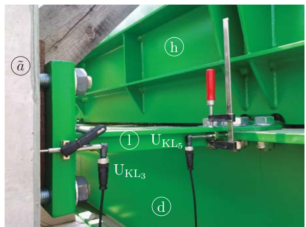
(b) Wegaufnehmer U_{KL3} , U_{KL5} - Kontrolle der Schraubverbindungen
