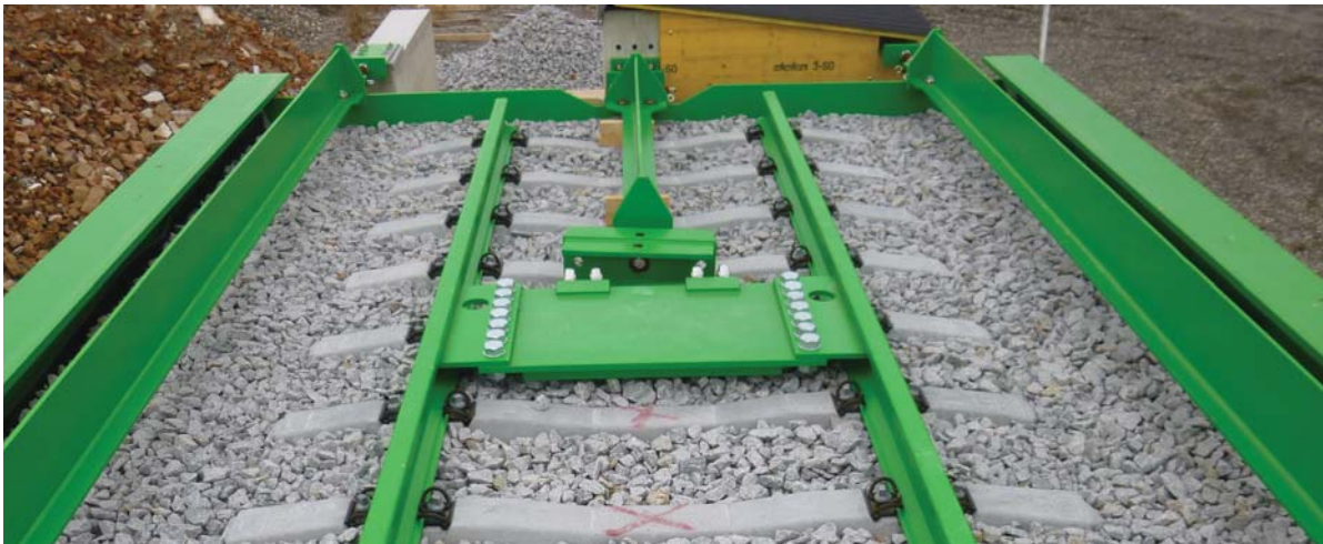
Abbildung 5.9: Versuchsanlage mit Schotteroberbau mit entkoppelter Ankerstange
