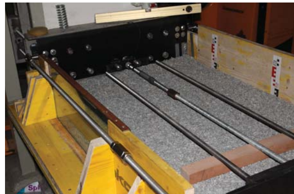
(b) Schienen und Kraftmessung an der Ankerstange
