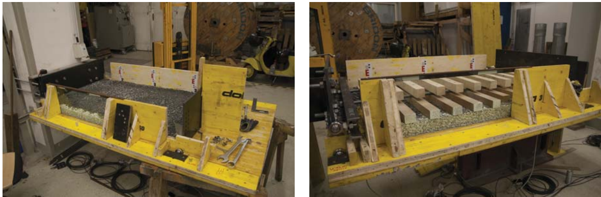
(a) Planum vor Gleiseinbau
