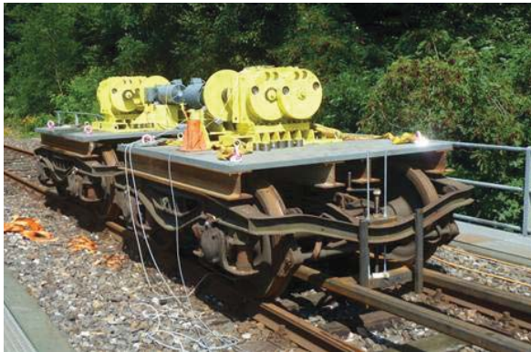
(a) Unwuchterreger auf Drehgestellen (aus [Kir12])
