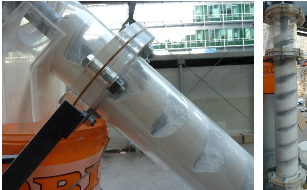
Abbildung 34: Förderschnecke in Betrieb bei 45° und 90° Steigung
