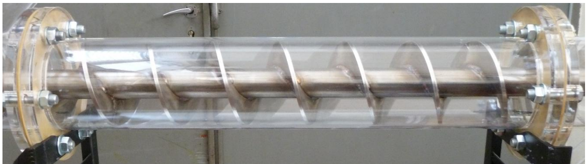
Abbildung 31: PMMA-Mantel mit Förderschnecke
