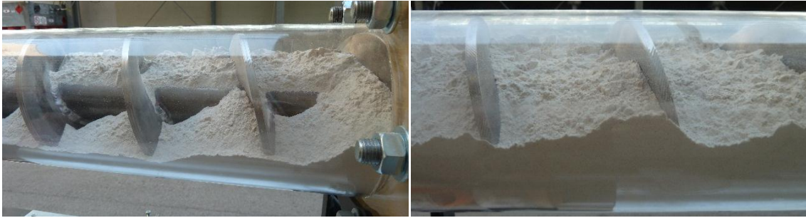
Abbildung 33: Förderschnecke in horizontalem Betrieb bei verschiedenen Füllgraden
