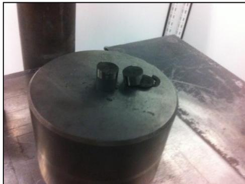
Abbildung 48: Schichtweise zerfallener Pellet der Charge 1; Beim Ausspannen war ein leises Knacksen wahr zu nehmen, das auf eine radiale Ausdehnung beim Ausspannen hindeutet
