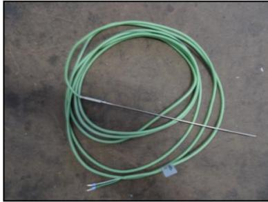
Abbildung 34: Thermoelement des Typs K mit Silikonkabel
