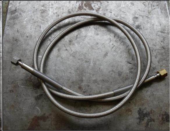
Abbildung 16: Wasserstoffdruckschlauch; geprüft nach Druckgeräterichtlinie EN 97/23, DIN EN ISO 14113, EN ISO 10380
