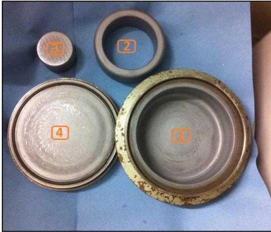
Abbildung 41: Mahlbehälter; 1 Mahltrog, 2 Ring, 3 Zylinder, 4 Deckel
