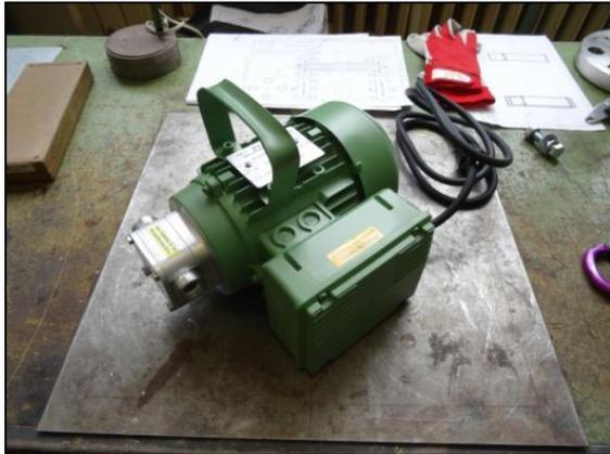
Abbildung 30: Pumpe Unistar 2000-A, 230V, 1400 U/min, 15 l/min; *Sinntec Schmiersysteme GesmbH*
