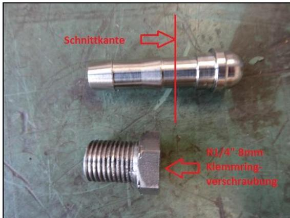
Abbildung 20: 3/8" Schlauchtülle und R1/4" 8mm Klemmringverschraubung
