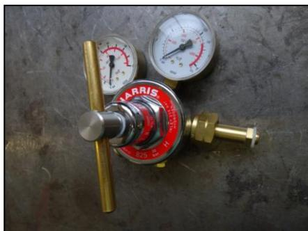
Abbildung 18: Wasserstoff-Flaschendruckminderer der Firma *Harris Calorific GesmbH*
