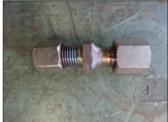
Abbildung 21: Fertig geschweißter Adapter für die Ausgangsseite am Druckminderer; rechte Seite 3/8" Schlauchtülle mit passender 3/8" LH Überwurfmutter, linke Seite R1/4" 8mm Klemmringverschraubung mit R1/4" Überwurfmutter
