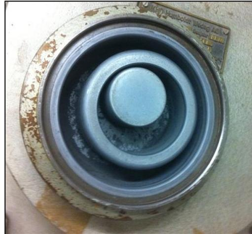
Abbildung 42: Zusammengesetzter Mahlkörper/Innenraum
