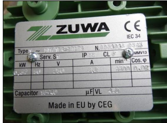
Abbildung 31: Typenschild der Impellerpumpe Unistar/V 2000-A; *Sinntec Schmiersysteme GesmbH*
