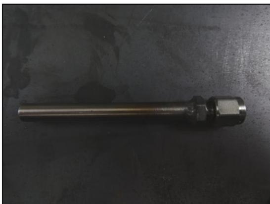
Abbildung 35: gefertigte Thermoelementklemmringverschraubung zur Positionierung in der Rohrleitung
