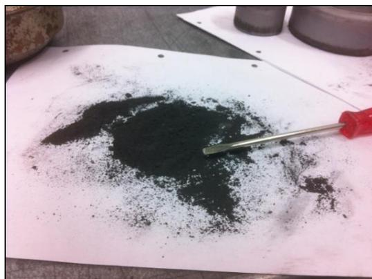
**Abbildung 44: Mahlgut nach der Entleerung des Mahlbehälters; Mahlzeit 5 min.**
