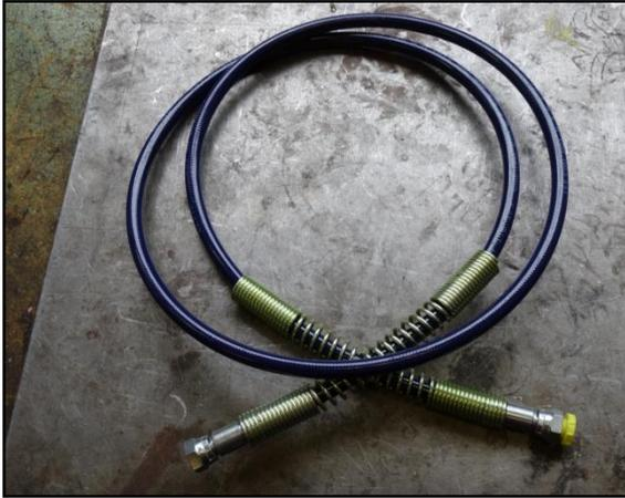
Abbildung 15: : Stickstoffdruckschlauch; geprüft nach Druckgeräterichtlinie EN 97/23, DIN EN ISO 14113, EN ISO 10380
