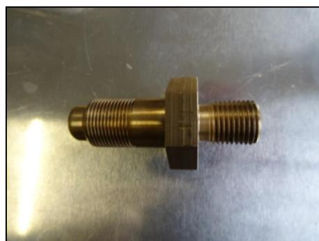
Abbildung 19: Einschraubstutzen; links Einschraubung Druckminderer, rechts R1/4“ Gewinde für 8mm Klemmringverschraubung
