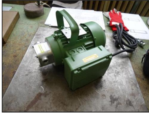
**Abbildung 38: Impellerpumpe Unistar/V 2000-A, 230V, 1400U/min, 15l/min; Sinntec Schmiersysteme GesmbH**
