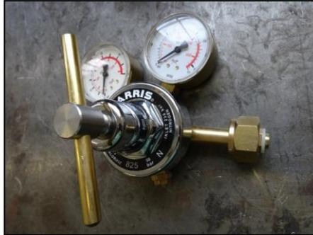
Abbildung 17: Stickstoff-Flaschendruckminderer der Firma *Harris Calorific GesmbH*
