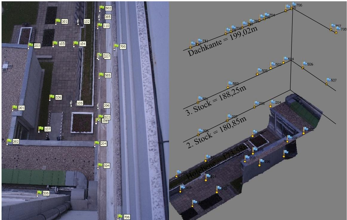
Abbildung 4.14: Foto des Innenhofs mit den vermessenen Passpunkten. Hier ist die Verteilung der Passpunkte über das gesamte Foto gut erkennbar.
