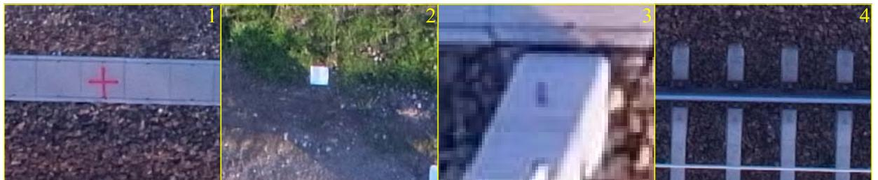
Abbildung 5.14: Die Abbildung zeigt ein beispielhaftes Bild und Detailausschnitte aus 40m Höhe mit einer Belichtungszeit von  $1/320$ , einer Blendenzahl von  $f/5.6$  und ISO-400. Darunter sind die Detailausschnitte von Markierungen (Passmarken (1) und Kreuze (2)), Mastbolzen (3) und Gleise (4) dargestellt.
