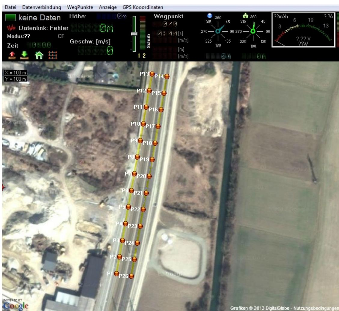
Abbildung 5.10: Flugplanung mit dem Programm *MikrokopterTool-OSD*. Die Werte aus der Tabelle 5.2 werden zur Wegpunktgenerierung verwendet (HiSystems GmbH, 2013).
