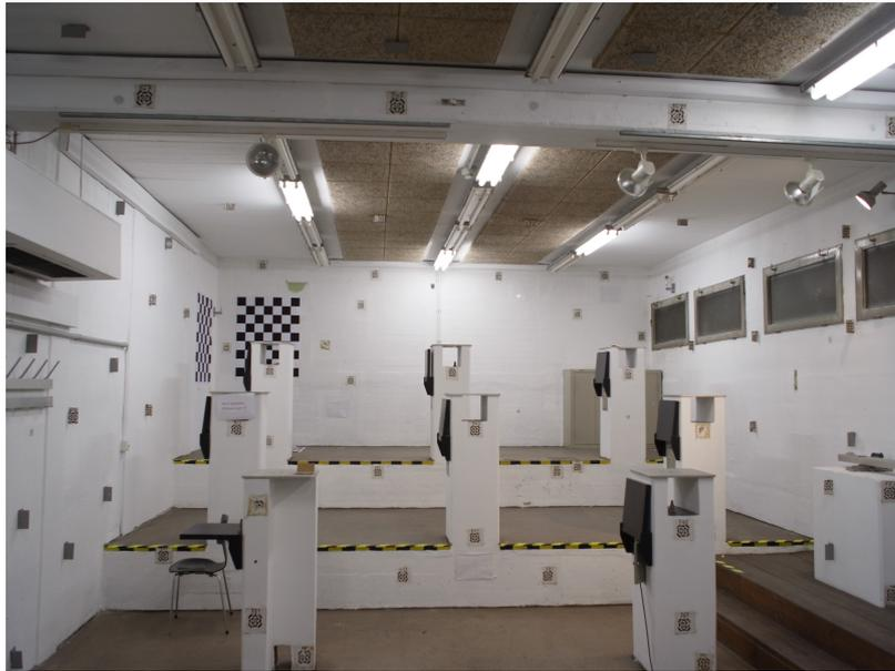
Abbildung 4.8: Das Passpunktfeld im Messkeller der TU Wien umfasst ca. 60 retroreflektierende Passmarken. Die räumlichen Ausdehnung beträgt etwa  $6,3 \times 5,7 \times 3,3\text{m}^3$ .
