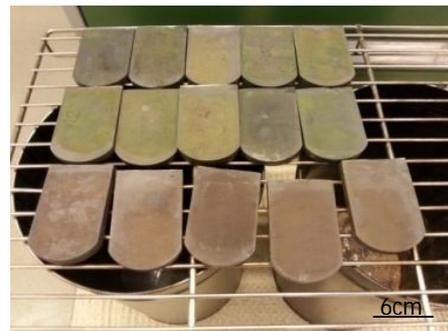
Abb.28: Luftabgekühlte Proben nach dem Intermediate Ageing
