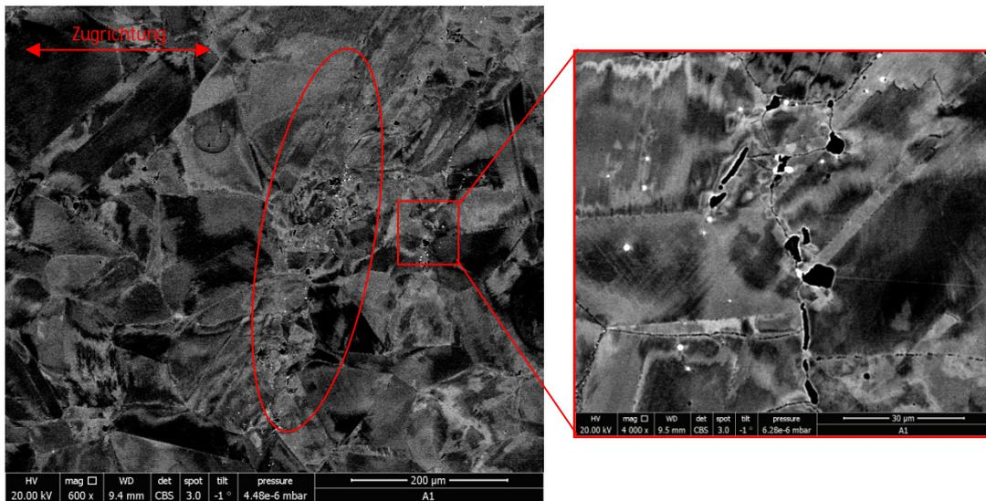
Abb.91: Probe A1 (A= 10%): zeilige Anordnung von MC – Karbiden und Mo – reichen Teilchen normal zur Zugrichtung
