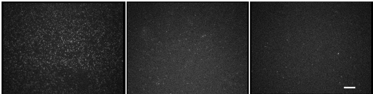
Abbildung 27 Verdünnungsreihe von Rhodamin 123: Ausgehend von der Stocklösung von 0,5 mM sind wir in Zehnerpotenzen fortgeschritten. Von links nach rechts sieht man 1:10^6 , 1:10^7 und 1:10^8 . Der weiße Balken entspricht 6 \mu\text{m} .
