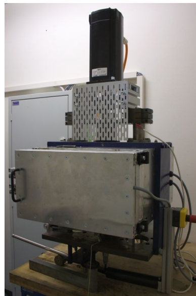
Abb. III.1: Ring-Reibung- und-Verschleiß Hochtemperatur Tribometer (RRT-HT Tribometer)
