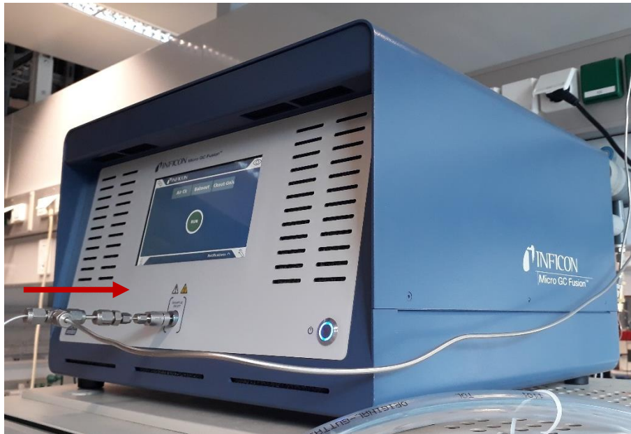
Abbildung 11: Inficon Micro-GC Fusion™, die zur Analyse der Reaktionsgase verwendet wurde. Der Probeneinlass ist durch den roten Pfeil hervorgehoben.
