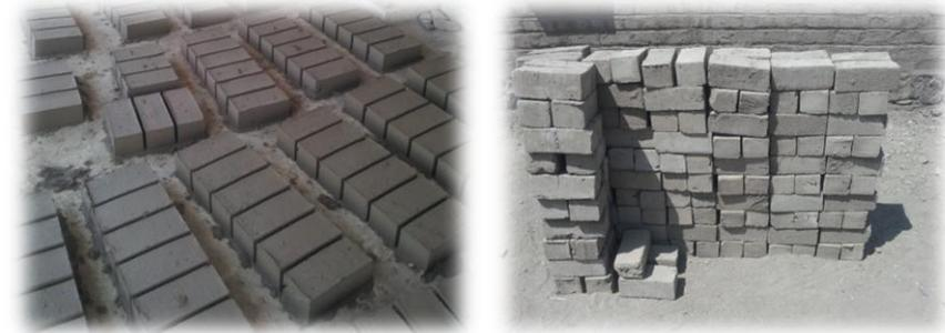
Abbildung 4-6 (von links nach rechts): gepatze Lehmsteine beim Trocknen und gestapelt
