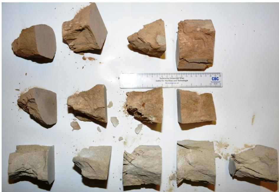
Abb. B.3: Übersicht der zerstörten Quarzsandsteinwürfel nach den experimentellen Untersuchungen
