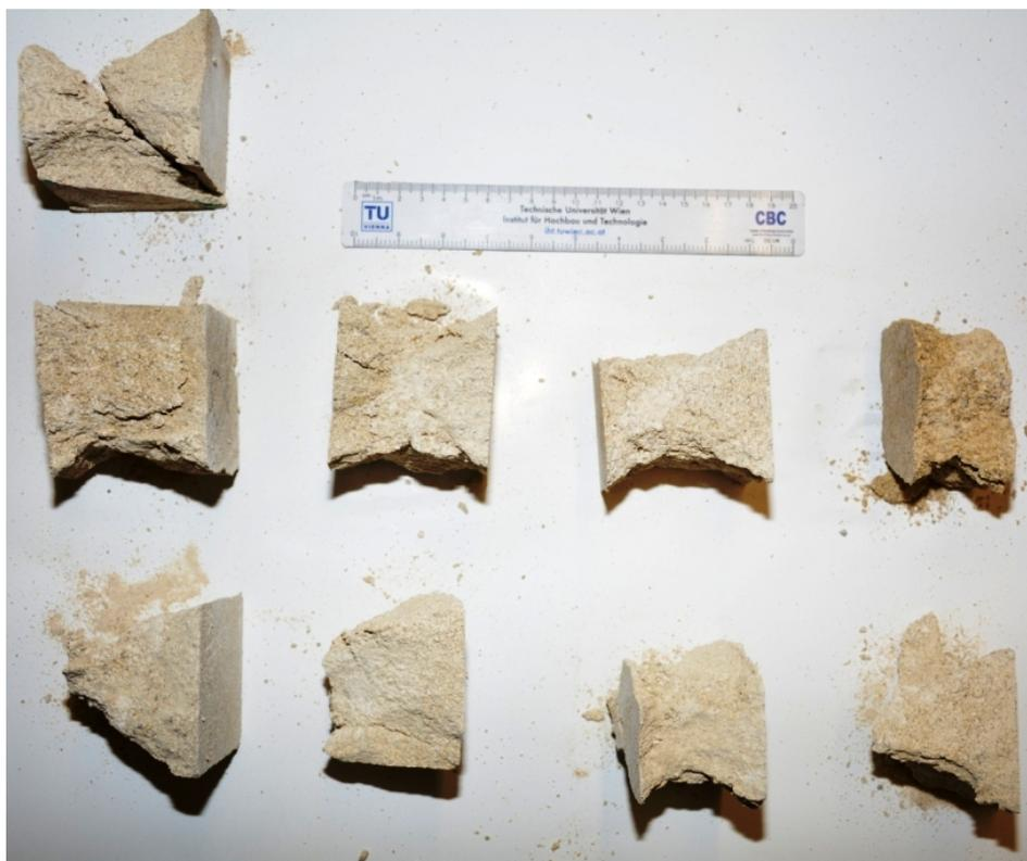
Abb. B.2: Übersicht der zerstörten Kalksandsteinwürfel nach den experimentellen Untersuchungen
