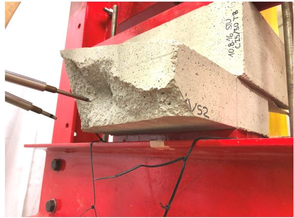
(b) Versuchsaufbau beim zweiten Vorversuch mit Bruchbild
