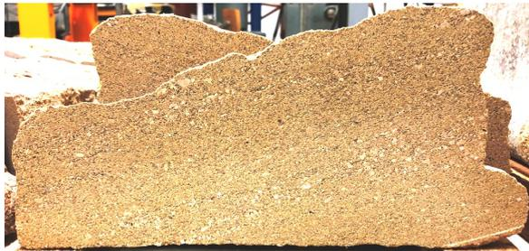
(a) Querschnitt der dritten Kalksandsteinstufe
