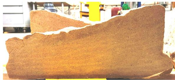
(b) Querschnitt der dritten Quarzsandsteinstufe
