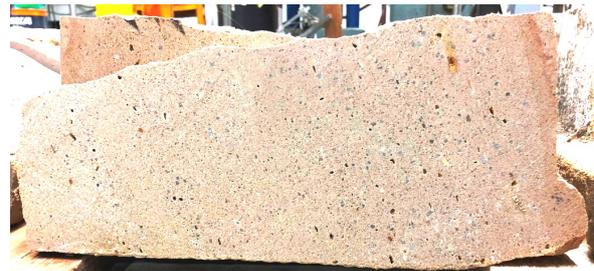
(b) Querschnitt der ersten Quarzsandsteinstufe
