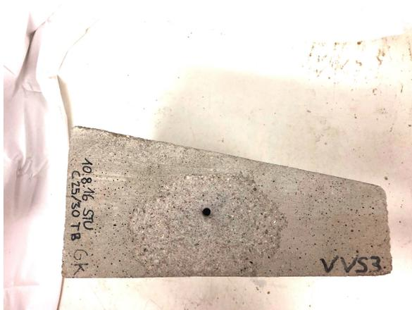
(a) Bruchbild des Betonprobekörpers beim dritten Vorversuch
