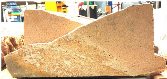
(a) Querschnitt der zweiten Quarzsandsteinstufe
