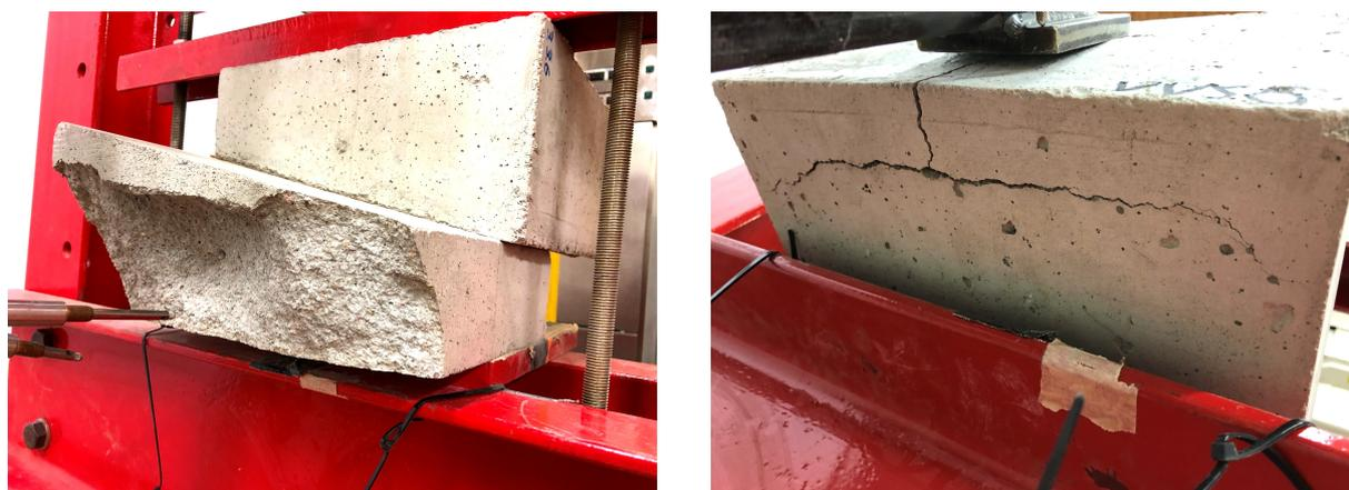
(a) Bruchbild des Betonprobekörpers beim fünften Vorversuch
