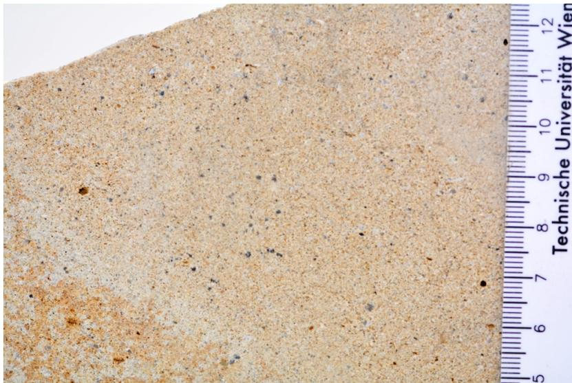
**Abb. 3.3:** Schnittfläche des verwendeten Quarzsandstein
