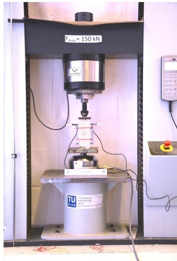
(b) Versuchsaufbau für die Bestimmung des Elastizitätsmoduls
