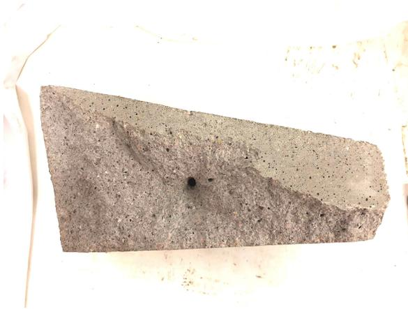
(a) Bruchbild des Betonprobekörpers beim zweiten Vorversuch
