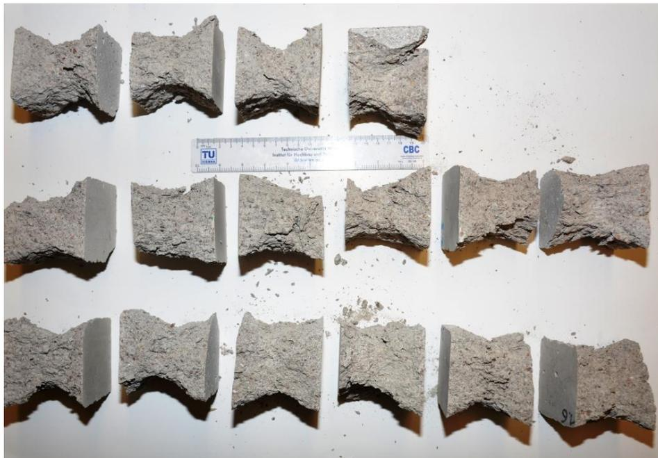
**Abb. B.1:** Übersicht der zerstörten Betonwürfel nach den experimentellen Untersuchungen
