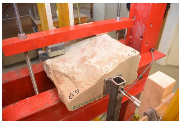
(b) Darstellung der Lagerung der Natursteinprobekörper
