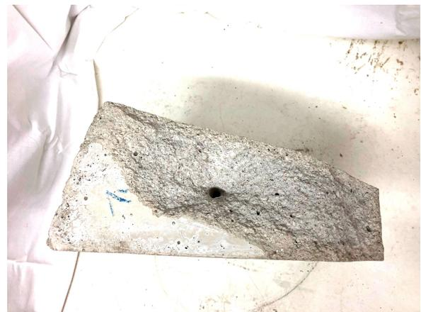
(b) Bruchbild des Betonprobekörpers beim vierten Vorversuch
