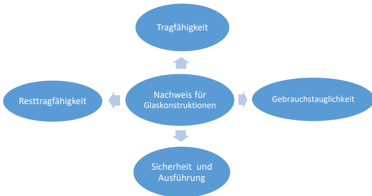
Abb. 19: Nachweise für Glaskonstruktionen (eigene Abbildung)
