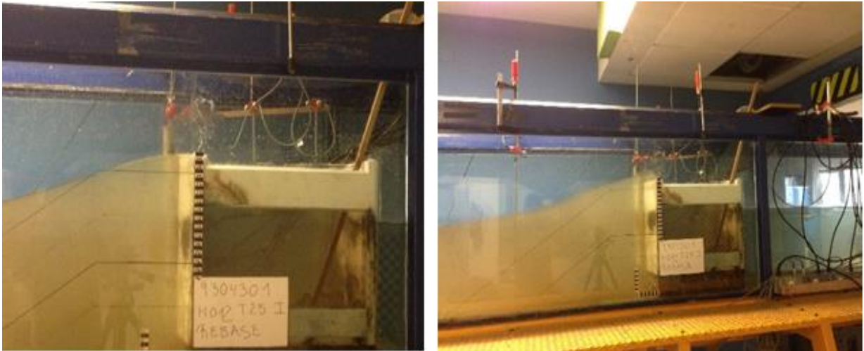
Abb. 49: Overtopping ohne Schüttung
