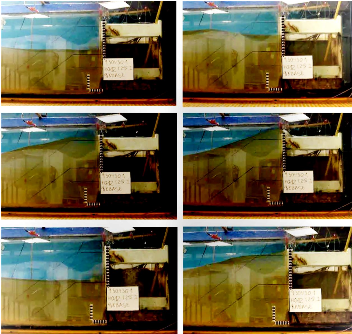
Abb. 53: Overtopping ohne Steinschüttung
