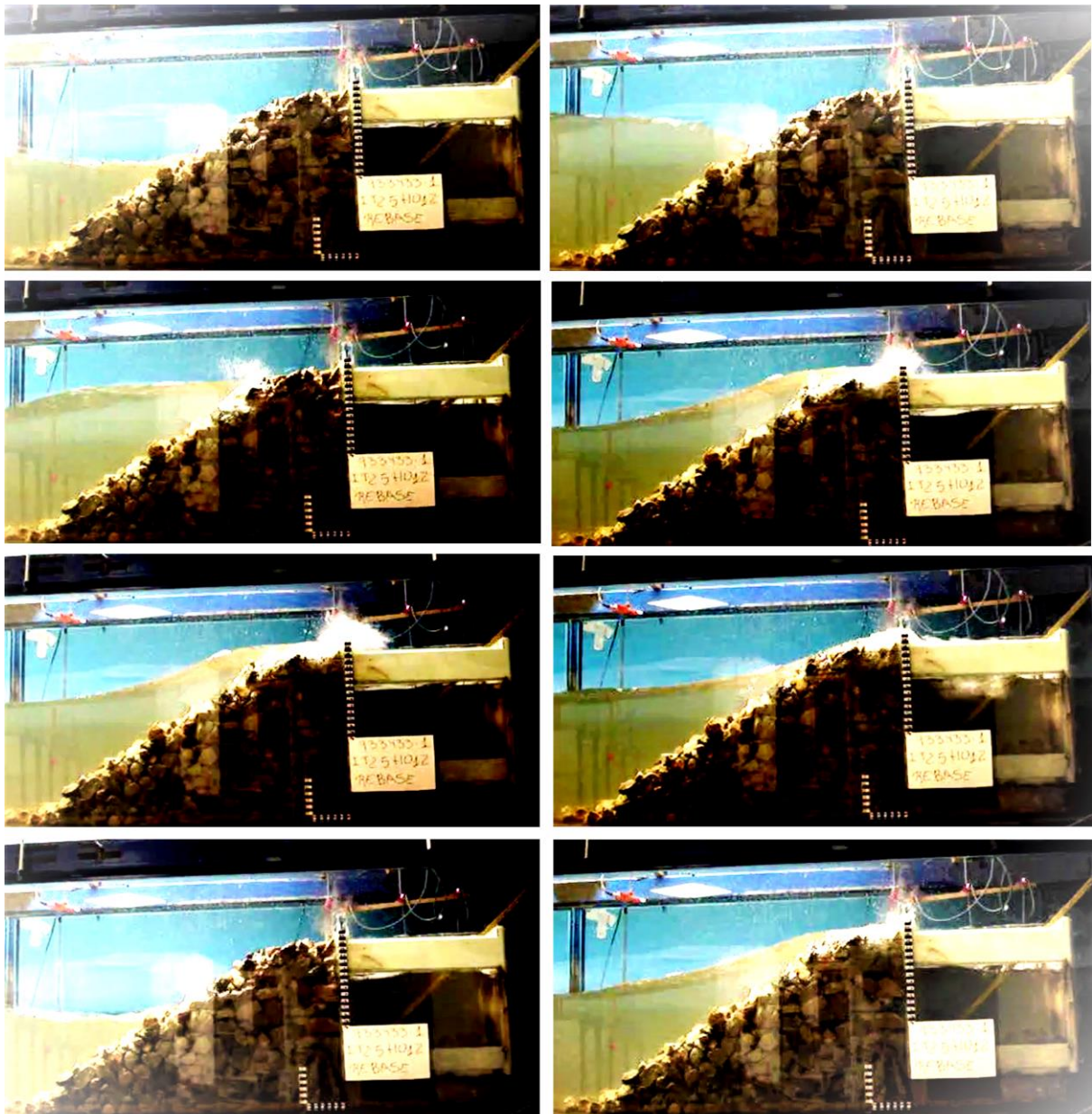
Abb. 54: Overtopping mit hoher Steinschüttung
