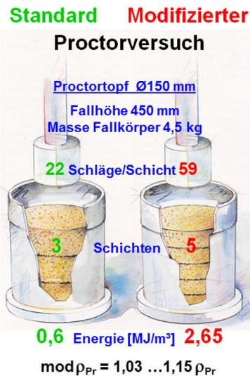
Abb. 2.1: Versuchsdurchführung des Proctorversuchs [1]
