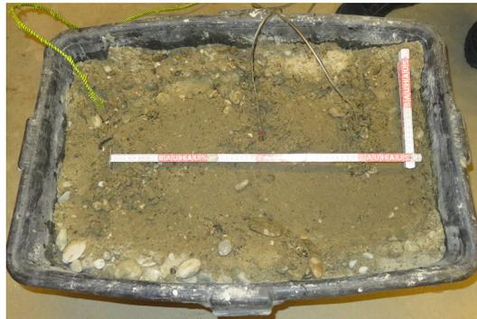
**Abb. 3.5:** Vergrabener Lautsprecher und Mikrophone im Labor
