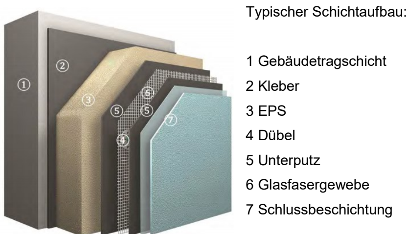
Abbildung 2.3: Schematischer Aufbau eines typischen WDVS [12]
