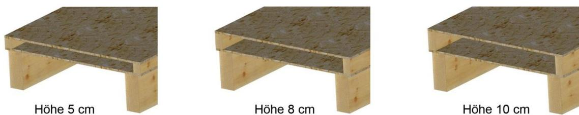
Abb. 4.3: Höhen der Belüftungsquerschnitte
