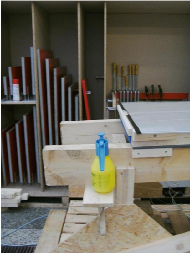
Abb. 5.6: Zufuhr des Ethanol mittels Sprühflasche
