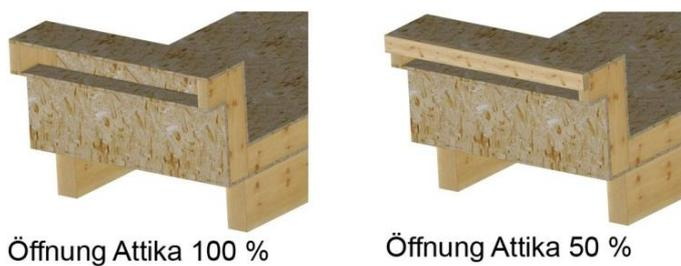
Abb. 4.5: Belüftungsöffnung mit Attika 100 und 50 %
