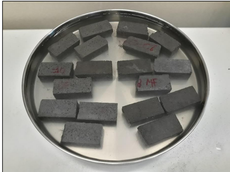
Abbildung 47: Prüfverfahren: Wasseraufnahme bei vollständiger Wasserlagerung
