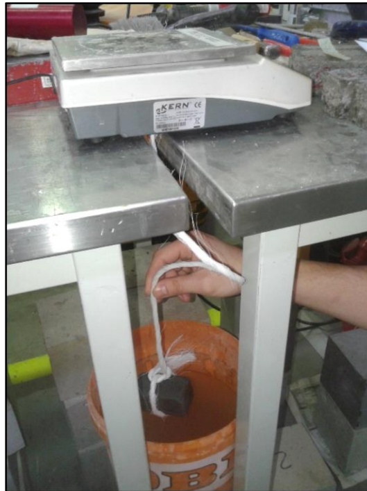
Abbildung 48: Unterwasserwägung mit der Hilfe des archimedischen Prinzips
