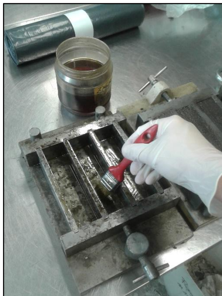
Abbildung 38: Vorbehandlung der Schalungen
