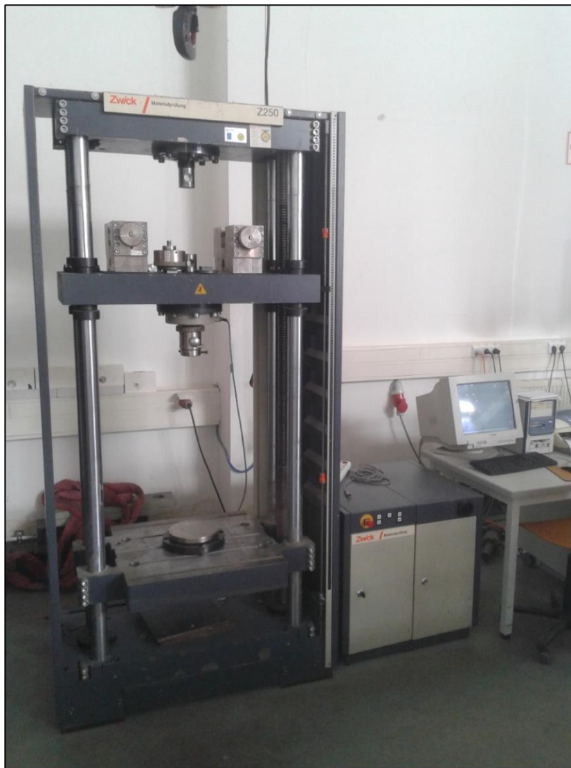
Abbildung 44: Prüfmaschine: Zwick Z 250
