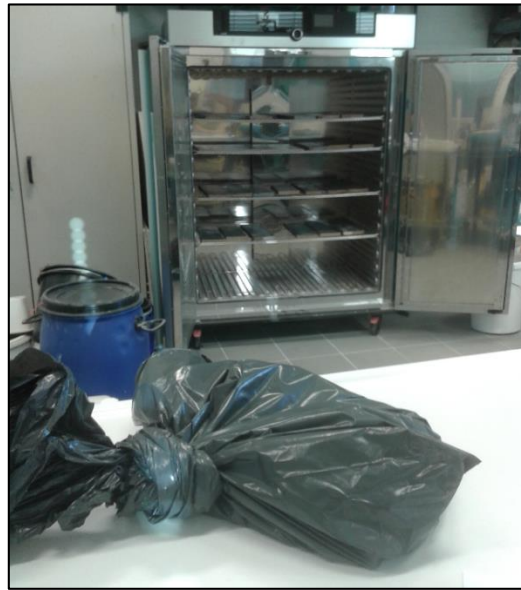
Abbildung 39: Gefüllte Schalung in der Plastikfolie und Umlufttrockenschrank
