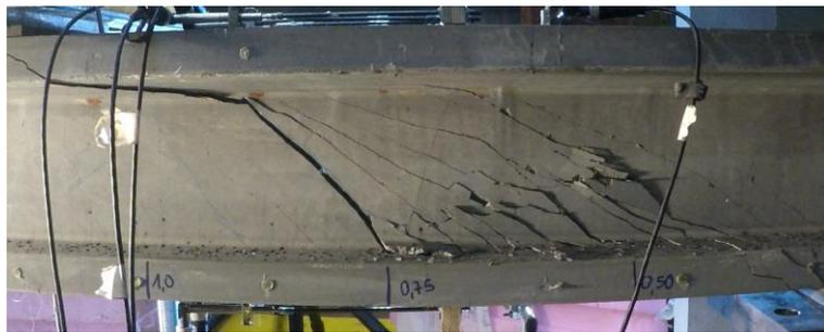
**Abb. 5-26:** Rissbild des Versuchsträgers V1-T06-Nr.12 bei einer Schubslankheit von  $a/d=4,0$
