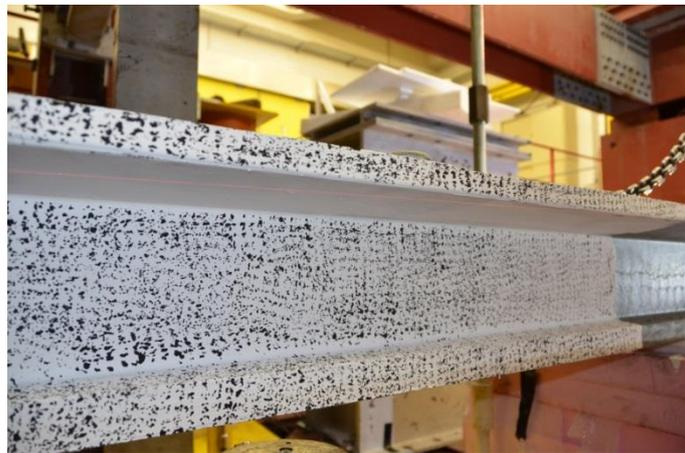
**Abb. 4-15:** Auftragung des stochastischen Musters auf dem Versuchskörper
