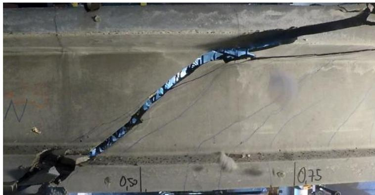
**Abb. 5-22:** Rissbild des Versuchsträgers V1-T06-Nr.12 bei einer Schubslankheit von  $a/d=3,0$
