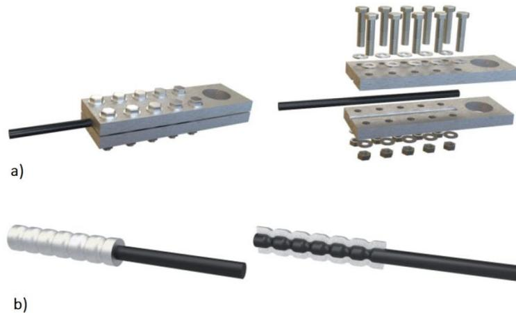
**Abb. 3-7:** a) Klemmverankerungen für CFK-Zugstäbe; b) Endverankerung durch Heissverformung [19]
