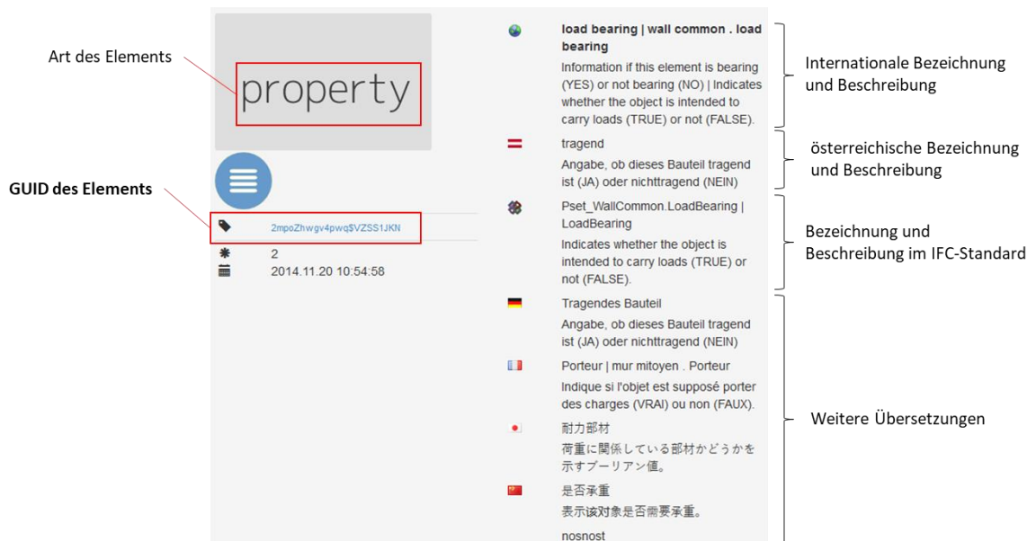
Abb. 4.1: GUID, Übersetzung und Bedeutung des Merkmals (property) „tragend“ (load bearing) aus der Merkmalliste Wand-Standard (wall common) im bSDD 80
