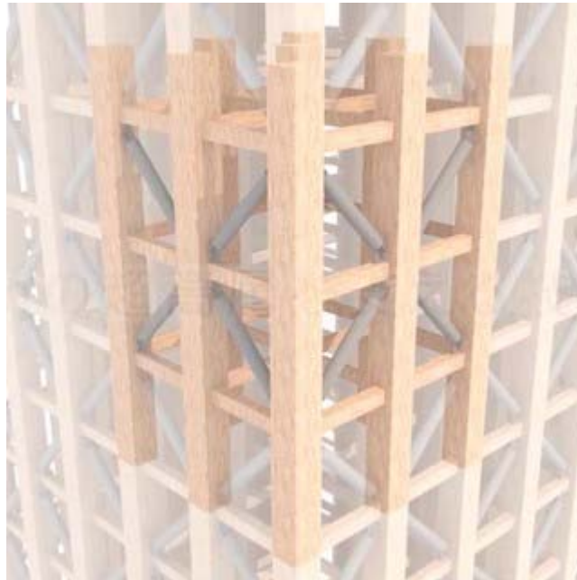
Abbildung 9.32: Aussteifungssystem mit diagonal angeordneten gedämpften Stahlrohren [133]
