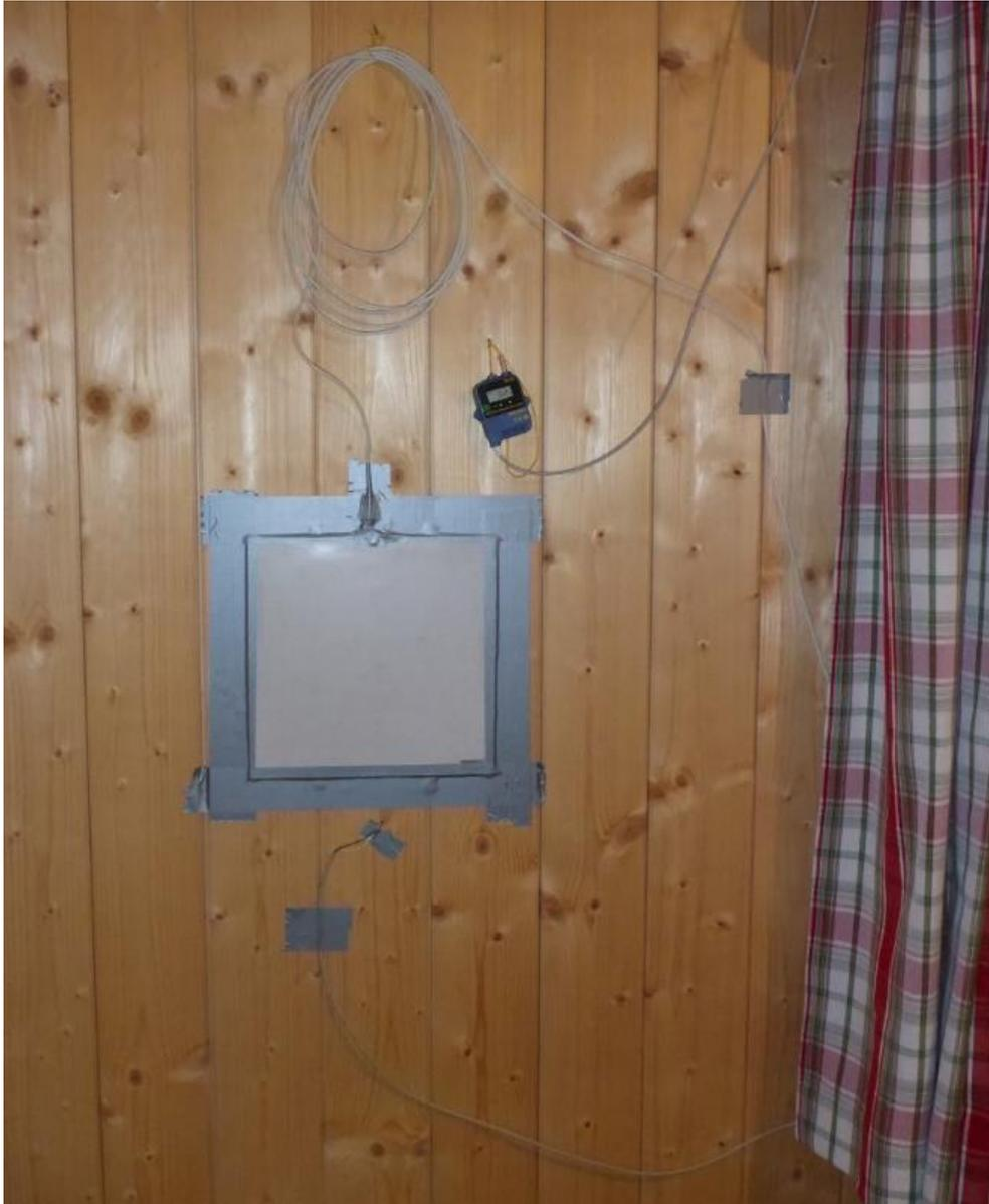
Abb. 14: Messfolie und Temperatursensor innen Endzustand
