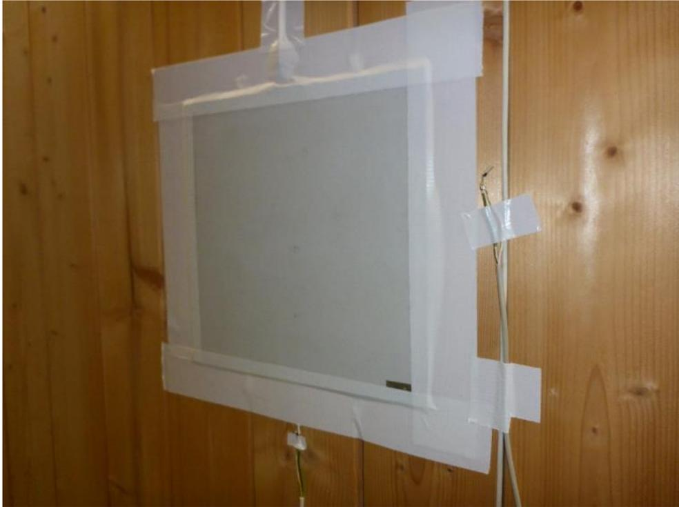
Abb. 19: Messfolie und Temperatursensor innen Endzustand
