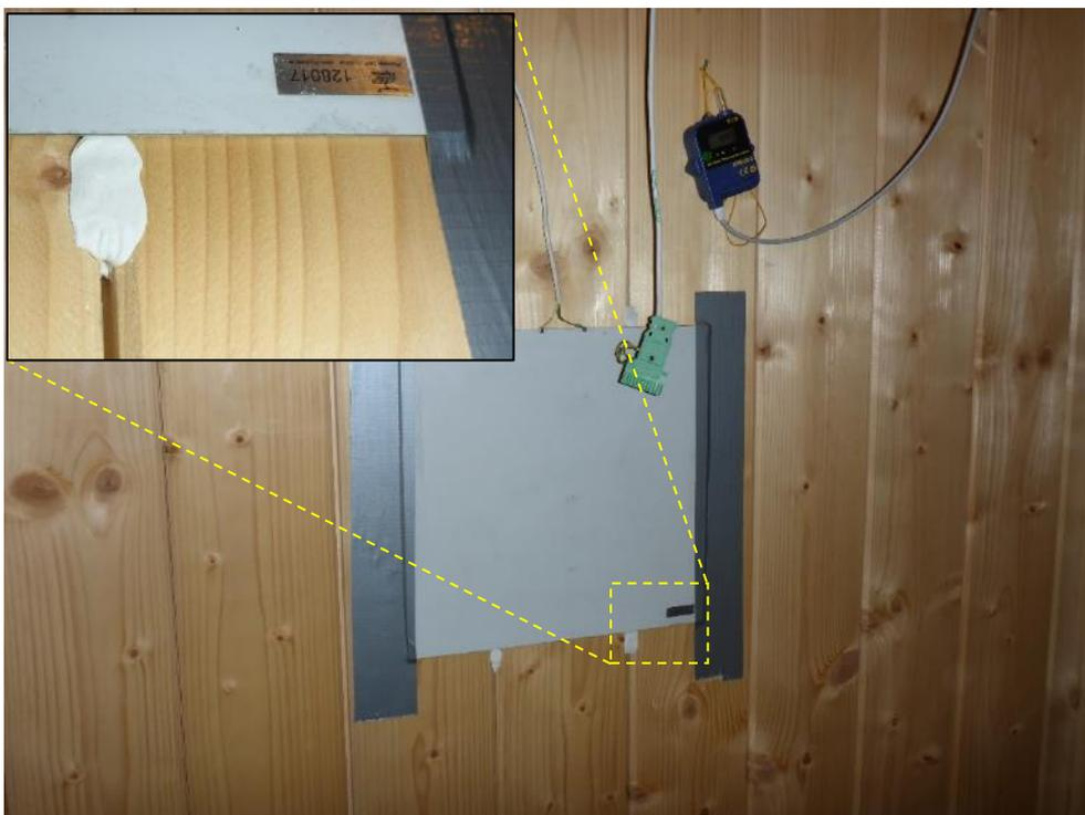
Abb. 13: Anbringung der Wärmestrommessfolie
