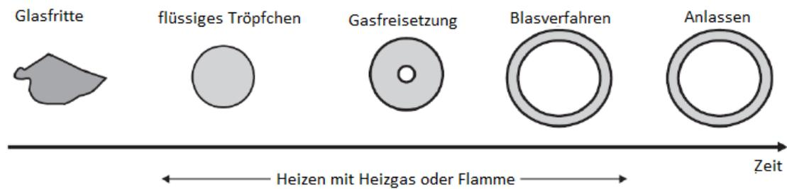
Abbildung 34: Sprühpyrolyse-Prozess zur Herstellung von Mikroglaskugeln [55]
