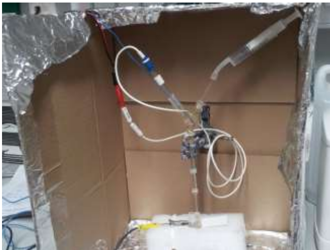
Abb. 13 Aufbau des potentiodynamischen Versuches
