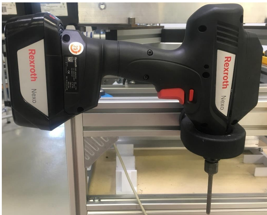
Abbildung 29: Akkuschauber mit integrierten Drehmoment- und Drehwinkelsensoren der Firma Bosch Rexroth
