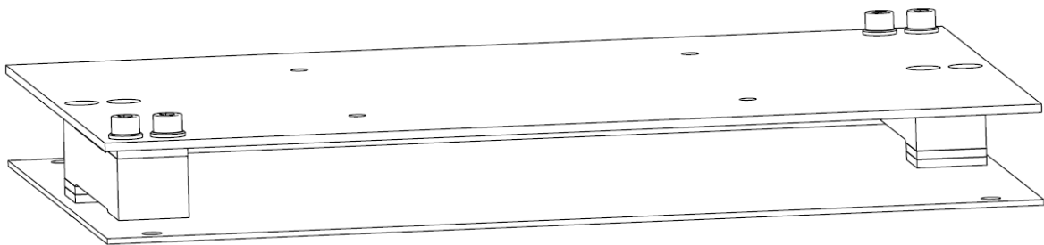
Abbildung 39: Isometrische Ansicht des umgesetzten Gewichtsmessungssystems
