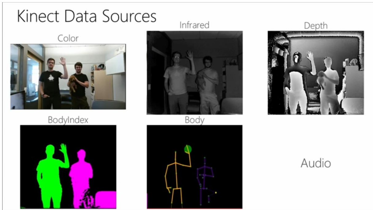
Abbildung 14: Daten aus dem Kinect Sensor
