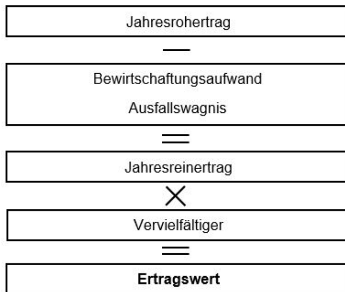
Abbildung 3 Verfahrensablauf einfaches Ertragswertverfahren
