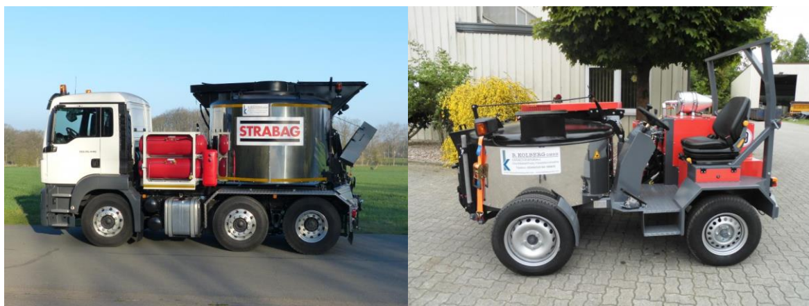
Abbildung 7: Gussasphalt-Kocher (links), Gussasphalt-Dumper (rechts) [16]
