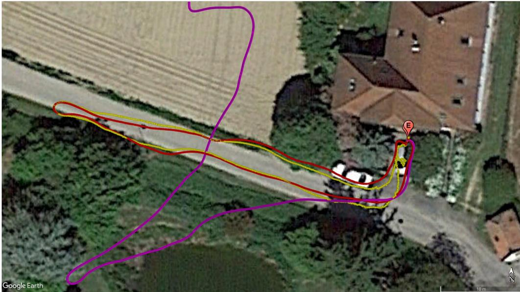
Abbildung 4.3: Testlauf mit konstanter Varianzzugabe  $\sigma_{gps,TL1}^2 = \sigma_{gps,start}^2 + 10$ ,
