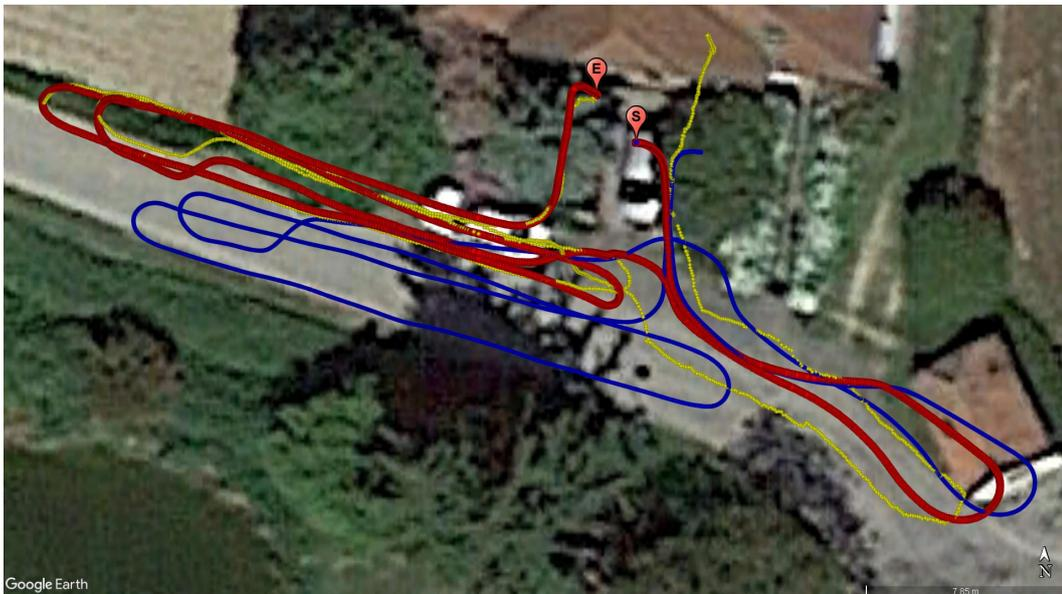
Abbildung 4.9: Testlauf mit um einen Faktor erhöhter Varianz  $\sigma_{gps,TL5}^2 = 18.5 \cdot \sigma_{gps}^2 + |\mathbf{r}_{S,P}| \cdot 0.97^k$  und  $\sigma_{gps,TL5}^2 \geq 14.5$ , © 2017 Google LLC, Verwendung mit Genehmigung. Google und das Google-Logo sind eingetragene Marken von Google LLC
