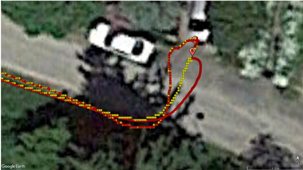
Abbildung 4.2: Testlauf mit konstanter Varianzzugabe  $\sigma_{gps,TL1}^2 = \sigma_{gps,start}^2 + 3$ ,
