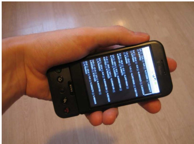
Abbildung 10: Experimentelle Sitzung mit DroidGlove implementiert auf einem HTC G1 Smartphone: Debug Information über Beschleunigung und Orientierung wird in Echtzeit am Bildschirm dargestellt.
