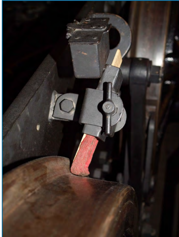
Abbildung 4.13 Fahrzeugseitige Spurkranzschmierung mit Schmierstift (rot)
