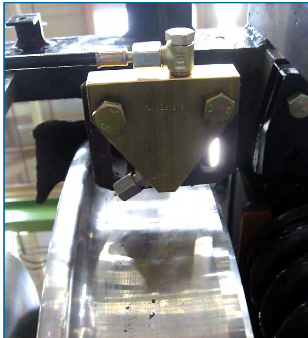
Abbildung 4.14 Fahrzeugseitige Spurkranzschmierung mit Sprühdüse [28]
