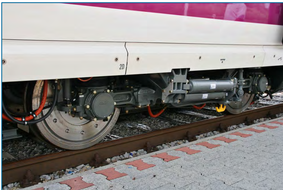
Abbildung 4.3 Velaro Drehgestell mit Radbremsscheiben [20]
