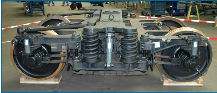
Abbildung 5.23 Minden-Deutz MD 52 Drehgestell mit Schraubenfedern und passiven Dämpfern (mittig) [61]
