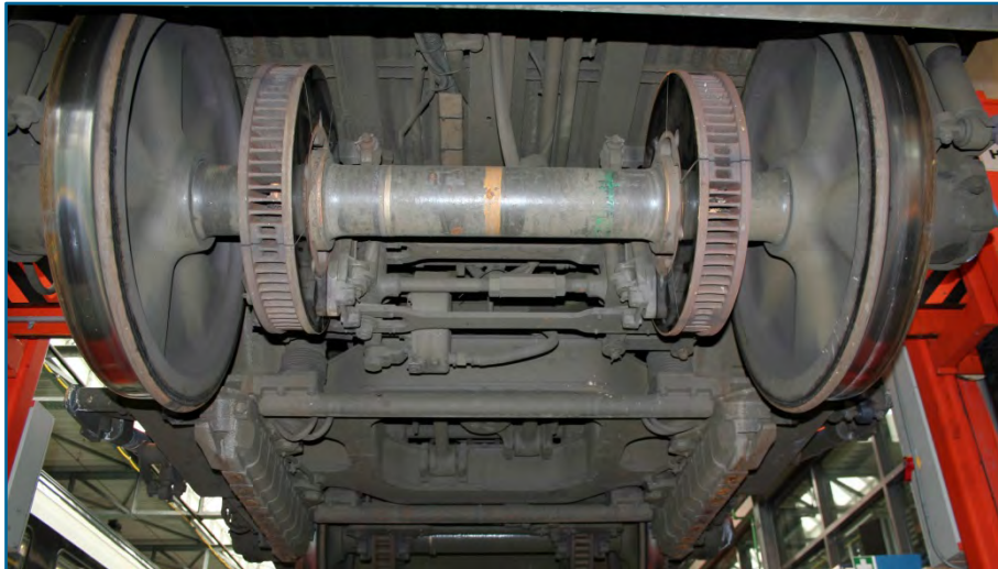
Abbildung 4.4 Drehgestell eines SBB Eurocity-Waggons mit Wellenbremsscheiben [21]
