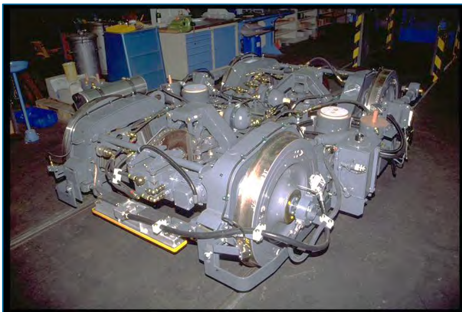
Abbildung 5.19 Drehgestell der Triebwagen TW 2000 der Stadtbahn Hannover mit hydropneumatischer Feder von Knorr-Bremse [56]
